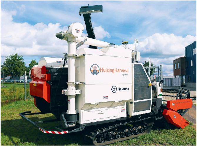
Der autonome Mähdrescher mit Raupenfahrwerk, 2-Meter-Schneidwerk und einem 1000-Liter-Korntank. Bild: Agrobotix
