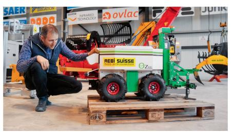
Der Hackroboter «Oz» ist der «kleine» im Angebot von Naïo. Neu ist er mit einer GPS-Antenne ausgerüstet. Damit kann der Roboter sehr genau in der Spur fahren.
