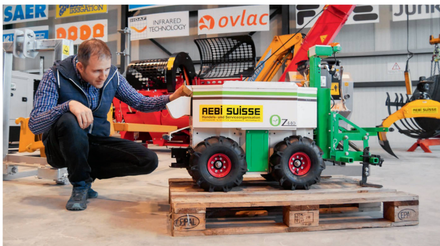
Der Hackroboter «Oz» ist der «kleine» im Angebot von Naïo. Neu ist er mit einer GPS-Antenne ausgerüstet. Damit kann der Roboter sehr genau in der Spur fahren.
