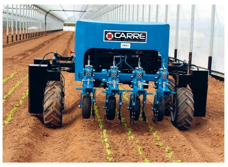
Der Jätroboter «Anatis» von Carré ist kamera- und GPS-gesteuert, wird von einer Lithiumbatterie mit acht bis zehn Stunden Laufzeit und drei Stunden Ladezeit angetrieben. Bild: Carré
