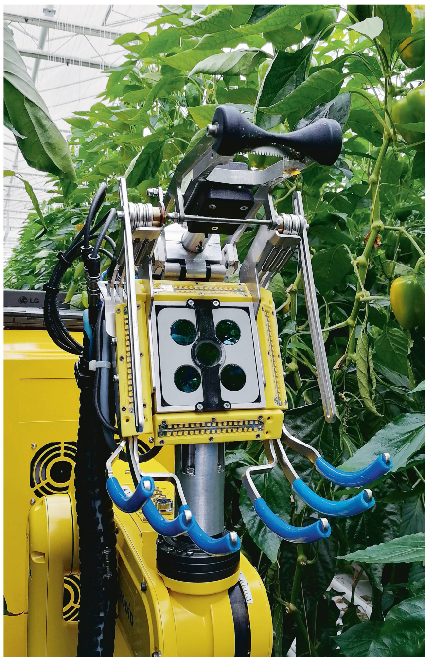
Der Pflückroboter «Sweeper» kann in Gewächshäusern dank 3D-Kamera selbstständig Peperoni pflücken. Die «Erfolgsquote» soll derzeit bei 62 % liegen. Bild: zvg
