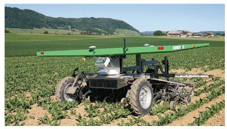
Mit einem Roboter des Typs Farmdroid «FD 20» wurden im Frühjahr 2020 einige Zuckerrübenfelder in der Ost- und Westschweiz gesät und anschliessend in mehreren Durchgängen gehackt. Bild: R. Engeler
