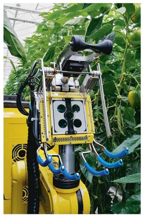
Der Pflückroboter «Sweeper» kann in Gewächshäusern dank 3D-Kamera selbstständig Peperoni pflücken. Die «Erfolgsquote» soll derzeit bei 62% liegen. Bild: zvg
