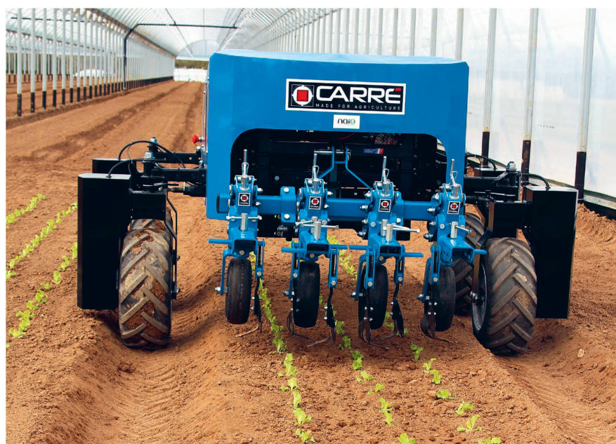
Der Jätroboter «Anatis» von Carré ist kamera- und GPS-gesteuert, wird von einer Lithiumbatterie mit acht bis zehn Stunden Laufzeit und drei Stunden Ladezeit angetrieben. Bild: Carré
