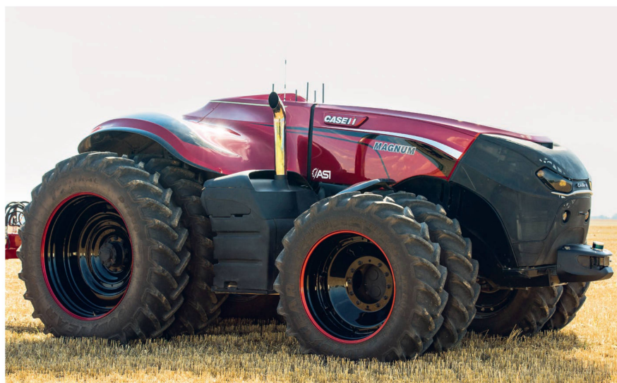
Mit Radar, Lidar und Videokameras an Bord erkennt dieser «Magnum» von Case IH stationäre und bewegliche Hindernisse auf seinem Weg und stoppt automatisch. Vorprogrammierte Aufgaben lassen sich über die Bedienoberfläche der Fernsteuerung ausführen. Bild: Case IH
