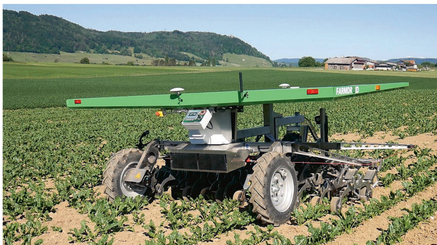
Mit einem Roboter des Typs Farmdroid «FD 20» wurden im Frühjahr 2020 einige Zuckerrübenfelder in der Ost- und Westschweiz gesät und anschliessend in mehreren Durchgängen gehackt. Bild: R. Engeler
