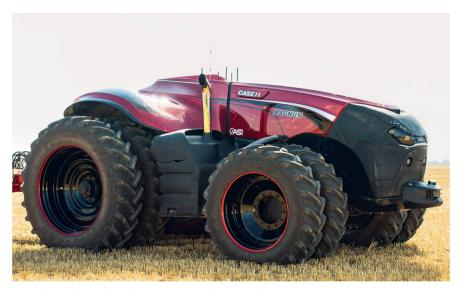
Mit Radar, Lidar und Videokameras an Bord erkennt dieser «Magnum» von Case IH stationäre und bewegliche Hindernisse auf seinem Weg und stoppt automatisch. Vorprogrammierte Aufgaben lassen sich über die Bedienoberfläche der Fernsteuerung ausführen. Bild: Case IH
