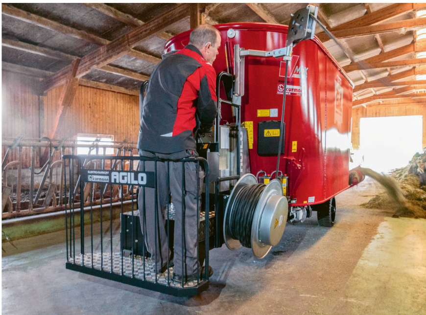
Mit «Agilo 2-S» gibt es den Elektro-Antrieb bei Kurmann nun auch für Zwei-Schnecken-Mischer von BvL. Bilder: R. Engeler
