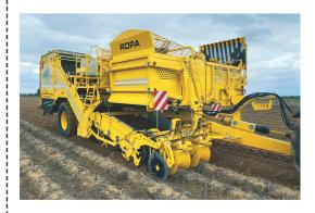
Ropa hat zur diesjährigen Erntesaison den Kartoffelroder «Keiler 2 Classic» testweise mit einem «XL»-Bunker ausgerüstet und verbaut diesen zur Saison 2021 standardmässig. Dies ermöglicht es Landwirten, die Maschine bei höchster Kartoffelschonung bestmöglich auszulasten. Ebenso stehen zur Erntesaison 2021 weitere neue
