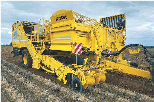
Funktionen in Serie und optional zur Verfügung. Weiter ist eine lastabhängige Igelautomatik in Verbindung mit der Siebketteneautomatik für verstopfungsfreies Roden bei maximaler Auslastung ab sofort in allen «Keiler 2»-Modellen optional erhältlich. Ebenfalls zur Saison 2021 bietet Ropa eine optionale Wiegeeinrichtung an.
