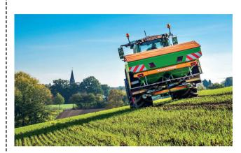
Für eine permanente Regelung, also auch innerhalb der 25 kg Regelintervalle der Wiegetechnik, sind bei Amazone die Anbaustreuer «ZA-TS» sowie die gezogenen Streuer «ZG-TS 01» nun mit dem neuen intelligenten Wiegesystem «ProfisPro» lieferbar. «ProfisPro» umfasst die Interaktion der Wiegetechnik «Profis» mit der neuen Drehmomentmessung «FlowControl». Dabei verfügt «FlowControl» über jeweils einen Sensor pro Streuscheibe, der die Drehmomente der einzelnen Streuscheibe ermittelt.
