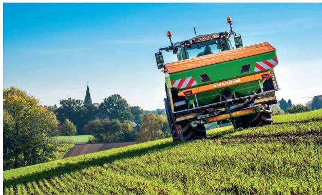
Für eine permanente Regelung, also auch innerhalb der 25 kg Regelintervalle der Wiegetechnik, sind bei Amazone die Anbaustreuer «ZA-TS» sowie die gezogenen Streuer «ZG-TS 01» nun mit dem neuen intelligenten Wiegesystem «ProfisPro» lieferbar. «ProfisPro» umfasst die Interaktion der Wiegetechnik «Profis» mit der neuen Drehmomentmessung «FlowControl». Dabei verfügt «FlowControl» über jeweils einen Sensor pro Streuscheibe, der die Drehmomente der einzelnen Streuscheibe ermittelt.
