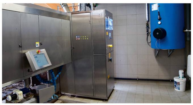
Überschüssige Energie aus Fotovoltaik (oder Windkraft) wird auf dem Hof von Franz X. Demmel aus dem bayrischen Schönrain bei Königsdorf für die Aufbereitung von Kochendwasser für die Melkanlage, hier von Lemmer-Fullwood, verwendet. D. Senn
