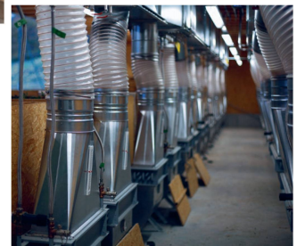
Eine Samentrocknungsanlage mit Wärmetauscher.
