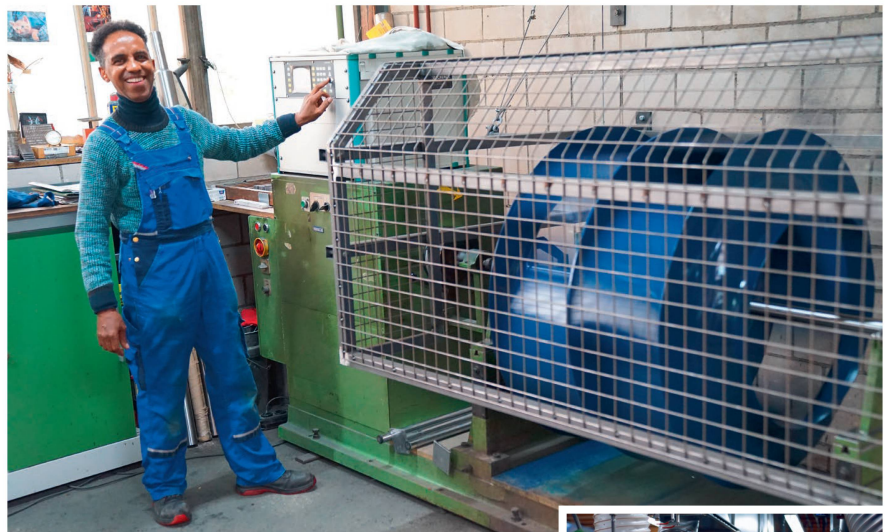
Ein Mitarbeiter beim präzisen Auswuchten einer Turbine.
