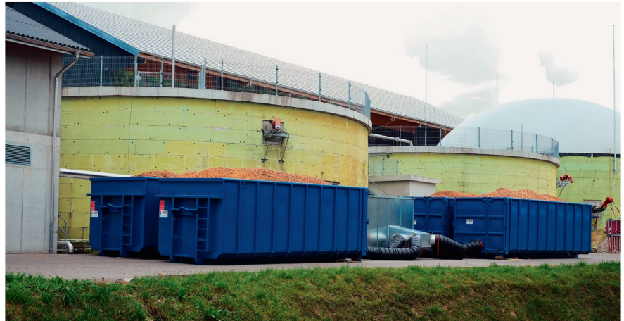
Die Holz Trocknung im Container, für welche die Abwärme der Biogasanlage im Hintergrund verwendet wird.
