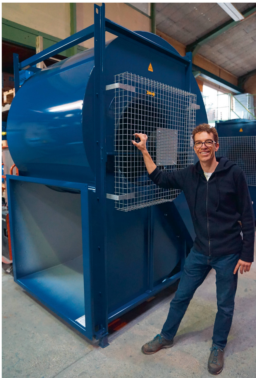
Der Kopf der Karl Barth AG Matthias Barth beim Herzstück der Trocknungsanlage, einem Hochleistungs-Radialventilator der Baureihe «Ventomat». Bilder: D. Senn/zvg
