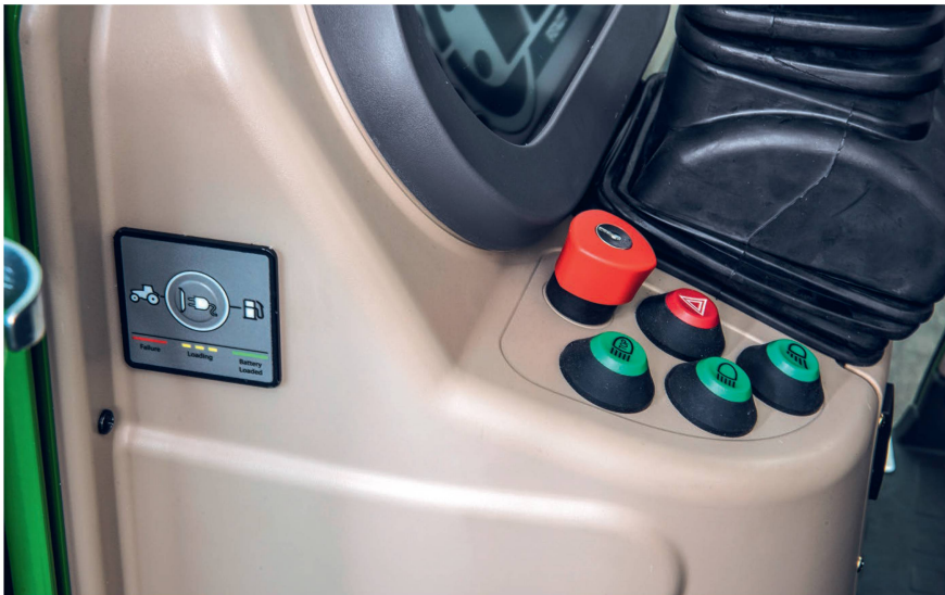
Wichtig ist, dass sowohl auf dem Traktor als auch auf dem Gerät ein Not-Aus-Schalter vorhanden ist.
