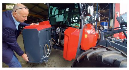
Das gesamte Kühlerpaket lässt sich werkzeuglos vom Fahrzeug/Motor wegschwenken.
