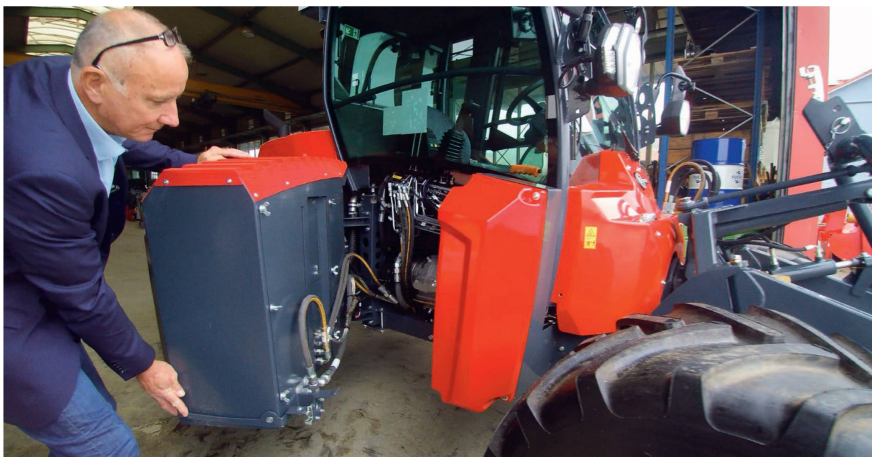
Das gesamte Kühlerpaket lässt sich werkzeuglos vom Fahrzeug/Motor wegschwenken.
