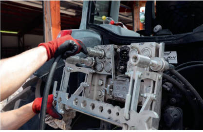
Alternativ können Leitungen auch ohne Geräte-Adapterplatte direkt mit der Basisstation (links) oder mit einer adaptierten Hilfsplatte gekuppelt werden (rechts).
