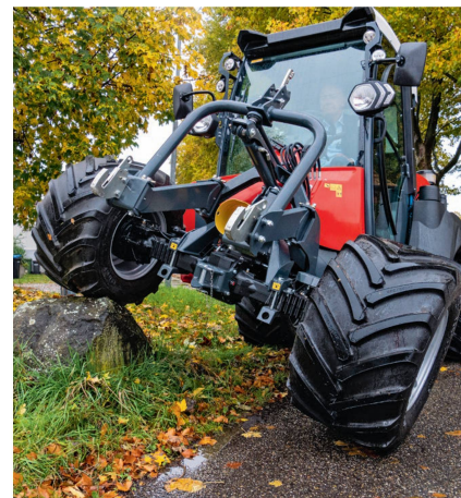
Der Pendelweg der Vorderachse beträgt 17°.
