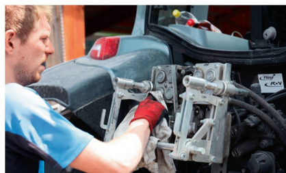
Mit dem Multifunktionsschlüssel führt man die geräteseitige Adapterplatte zur Basisstation und arretiert sie über den Totpunkt.
