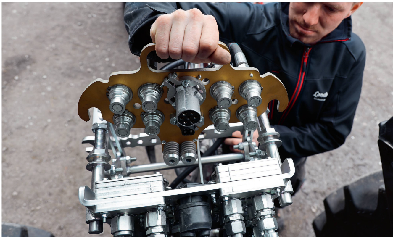
Mit dem «F-Con Multi» lassen sich bis zu acht Hydraulikleitungen, zwei Stromleitungen und die Druckluftbremse auf einmal kuppeln. Bilder: J. Paar
