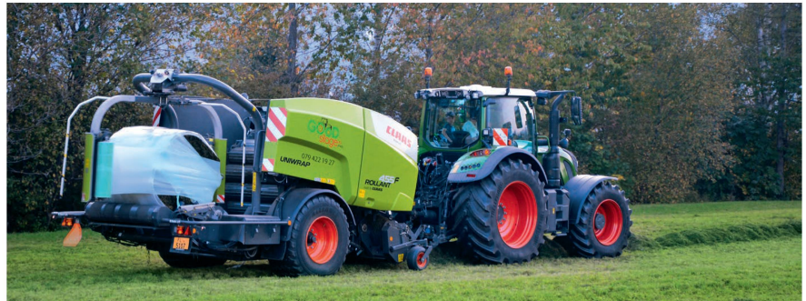
Dank Traktor-Implement-Management lässt sich der Traktor auch über das Anbaugerät steuern.
