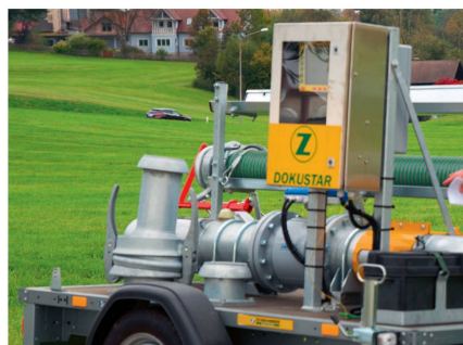
Der «Dokustar» erfasst beim Befüllvorgang das Volumen und die Inhaltsstoffe der Gülle.
