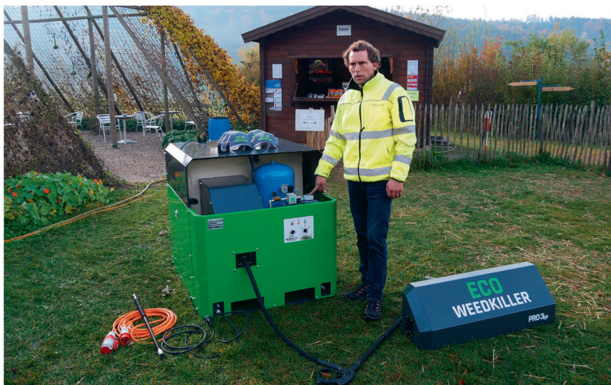
Hanspeter Bleuler: «Die 300 Liter Wasser im Tank werden vor dem Einsatz mit Strom auf 100 Grad erhitzt. Der Schlauch auf der integrierten Haspel ist 18 Meter lang.» Bilder: röt/zvg
