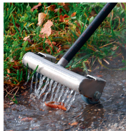
Das Heisswasser wird «übergossen». Hier der Einsatz mit der 18-cm-Lanze.
