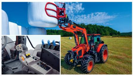
Die drei neuen «M6002»-Modelle bieten Leistungen von 123 bis 143 PS. Die Multifunktionsarmlehne ermöglicht den raschen Zugriff auf alle Schlüsselfunktionen. Bilder: Kubota
