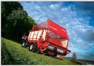
schwenkt, was die Arbeitsabläufe weiter vereinfacht. Für ein schnelles Entladen sorgt die teleskopierbare hintere Querstrebe auf dem Scherengitteraufbau. Diese fährt mit dem Hochschwenken der Hecktür automatisch hoch. Die Ladegeräte «LD 530» und «LD 540» sind für den kurzen und langen Radstand sowie in schmaler und breiter Ausführung erhältlich.
