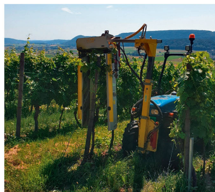
Ragen die Triebe über die Drahtanlage hinaus, kommt der Laubschneider zum Einsatz.
