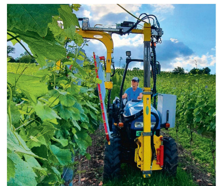
Der Aufbinder; die Klammern werden per Knopfdruck gesetzt.
