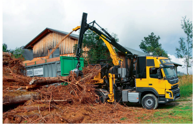
Neuster Wurf von Wüst ist der Lkw-Hacker «SMC-812» mit Direktantrieb. Die Bedienung erfolgt mit Drehsitz aus der Fahrerkabine.
