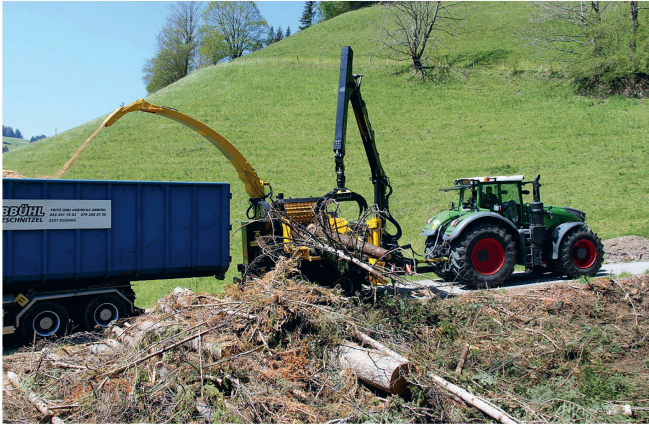
Die Wüst-«BBHK»-Hackaggregate können über Zapfwelle oder über einen Lkw-Aufbau direkt angetrieben werden. Bilder: Wüst
