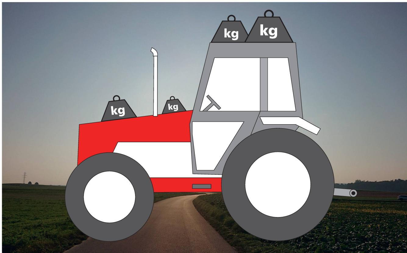
Mit einer Auflastung wird erreicht, dass der Traktor ein höheres zulässiges Gesamtgewicht und damit mehr Nutzlast erhält. Die maximalen Achsgewichte bleiben unverändert. Illustration: AVD
