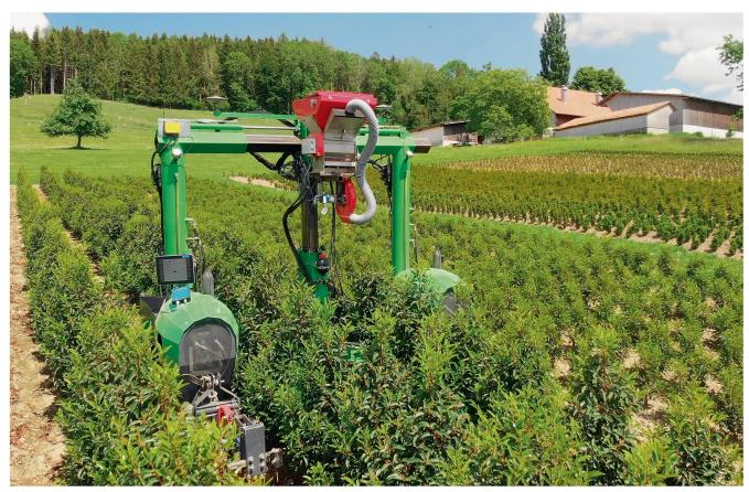
Der Geräteträger «Flunick» kann viele Arbeiten vollautomatisch ausführen. So können mit dem Hackgerät drei Zwischenräume in einem Durchgang bearbeitet werden. Bilder: R. Burkhalter
