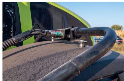
Abstehende Schläuche der Reifendruck-Regelanlage können für die Strassenfahrt auf den Kotflügeln in Parkposition gebracht werden.
