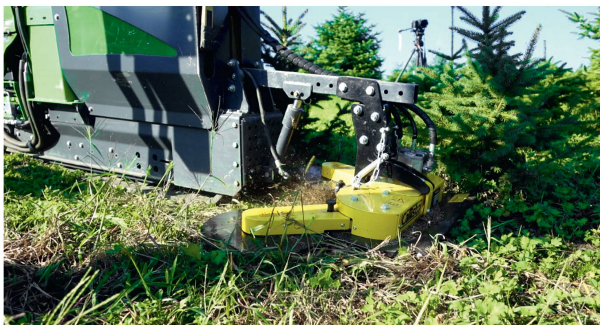
Am Geräteträger können beispielsweise bis zu drei Mulcher für Christbaumkulturen montiert werden.
