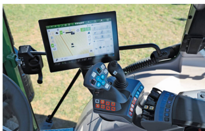
Elemente von «FendtOne» sind die neue Bedienarmlehne, der modifizierte Multifunktionshebel und das (optionale) Terminal.
