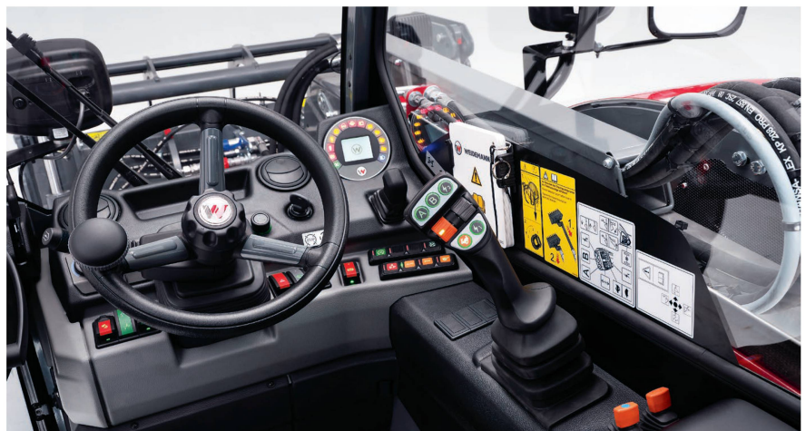
Die Bedienschalter sind nach einem Farbsystem angeordnet. Der Joystick wurde neu konzipiert. Bild: Weidemann
