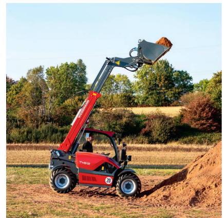
Das patentierte Fahrerassistenzsystem «vls» erhöht die Standsicherheit der Maschine.
