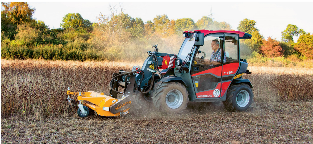
Der «T4512» – in der stärkeren Motorisierung – hier unterwegs mit einem hydraulisch angetriebenen Mulcher im Arbeitsgeräte-Modus.
