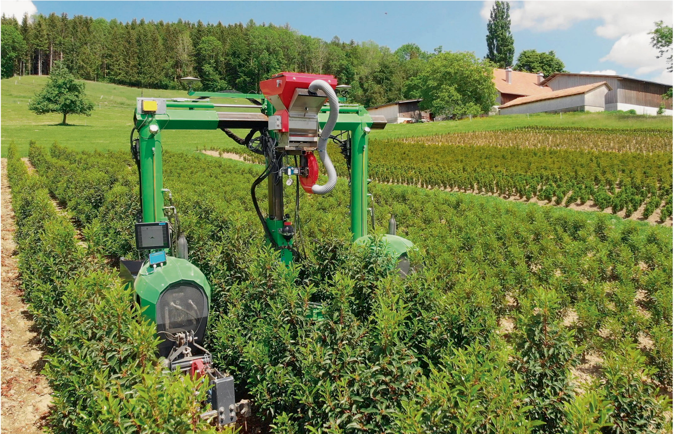
Der Geräteträger «Flunick» kann viele Arbeiten vollautomatisch ausführen. So können mit dem Hackgerät drei Zwischenräume in einem Durchgang bearbeitet werden. Bilder: R. Burkhalter
