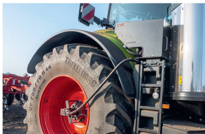
Werkseitig sind die «Axion 900»-Traktoren von Claas für den Betrieb mit der leistungsfähigen Reifendruck-Regelanlage «CTIC» vorgerüstet.
