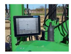
Bedient wird der Geräteträger über einen Touchscreen oder über eine Funksteuerung.
