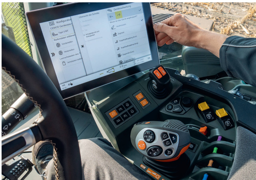
«Cemos» ist das neue Hirn des Traktors: Das Fahrerassistenz- und Optimierungssystem soll es dem Fahrer ermöglichen, das vorhandene Potenzial der Maschine noch besser ausnützen zu können.
