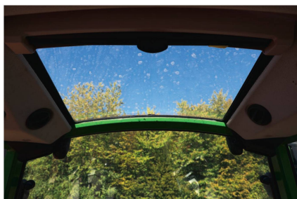
Die modifizierte Kabine mit hochgezogener Frontscheibe und schmalereem Steg zum Dachfenster.
