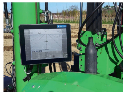
Bedient wird der Geräteträger über einen Touchscreen oder über eine Funksteuerung.
