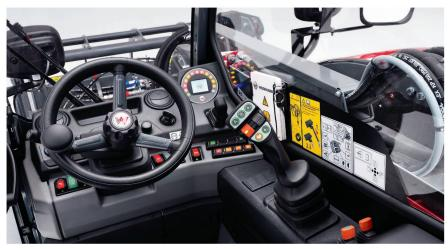
Die Bedienschalter sind nach einem Farbsystem angeordnet. Der Joystick wurde neu konzipiert. Bild: Weidemann
