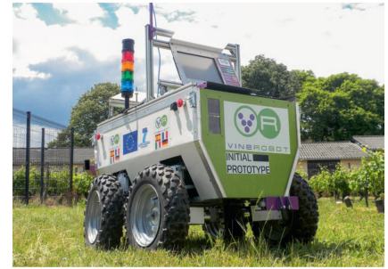
Der «VineRobot» erfasst Parameter wie Traubenertrag und -zusammensetzung oder vegetatives Wachstum. Bild: zVg
