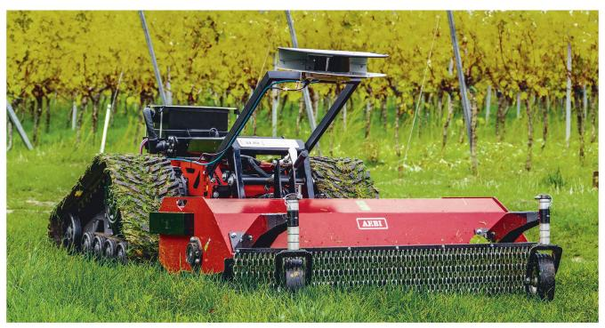
Ausgerüstet mit einem «Autonomiekit» für Reihenkulturen können geeignete Trägerfahrzeuge automatisiert werden. Bild: Robot Makers
