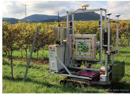
Dieser Phänotypisierungsroboter ist in erster Linie für die Rebenzüchtung gedacht. Bild: JKI
