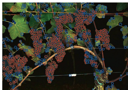
Computerbilder des «Phen0bot», die effektiven Traubenbeeren werden rot dargestellt. Bild: JKI
