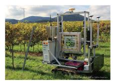
Dieser Phänotypisierungsroboter ist in erster Linie für die Rebenzüchtung gedacht.
