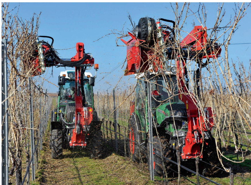
Vorschneider und Rebholzzieher erleichtern die Handarbeit zwar, aber machen sie nicht überflüssig. Bild: Ero
