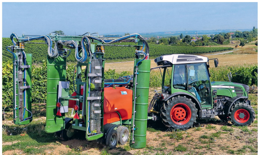
Leistungsfähiges Tangential-Sprühgerät für grosse und gut befahrbare Rebflächen. Bild: zVg
