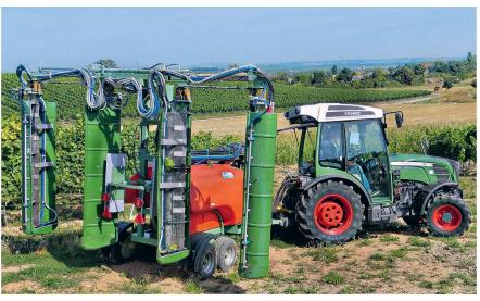
Leistungsfähiges Tangential-Sprühgerät für grosse und gut befahrbare Rebflächen. Bild: zVg
