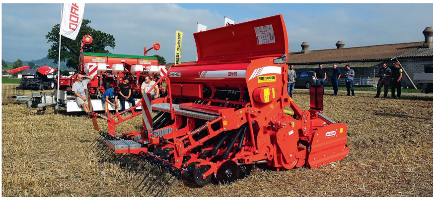
Die kompakter gewordene Aufbau-Drillkombination «Dama» gibt es in zwei neuen Varianten mit «Corex Plus»-Scheibenschar.
