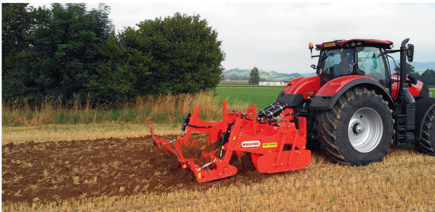
Der Tiefenlockerer «Attila» erledigt auf einer zweiten Ebene gleichzeitig auch die Stoppelbearbeitung.
