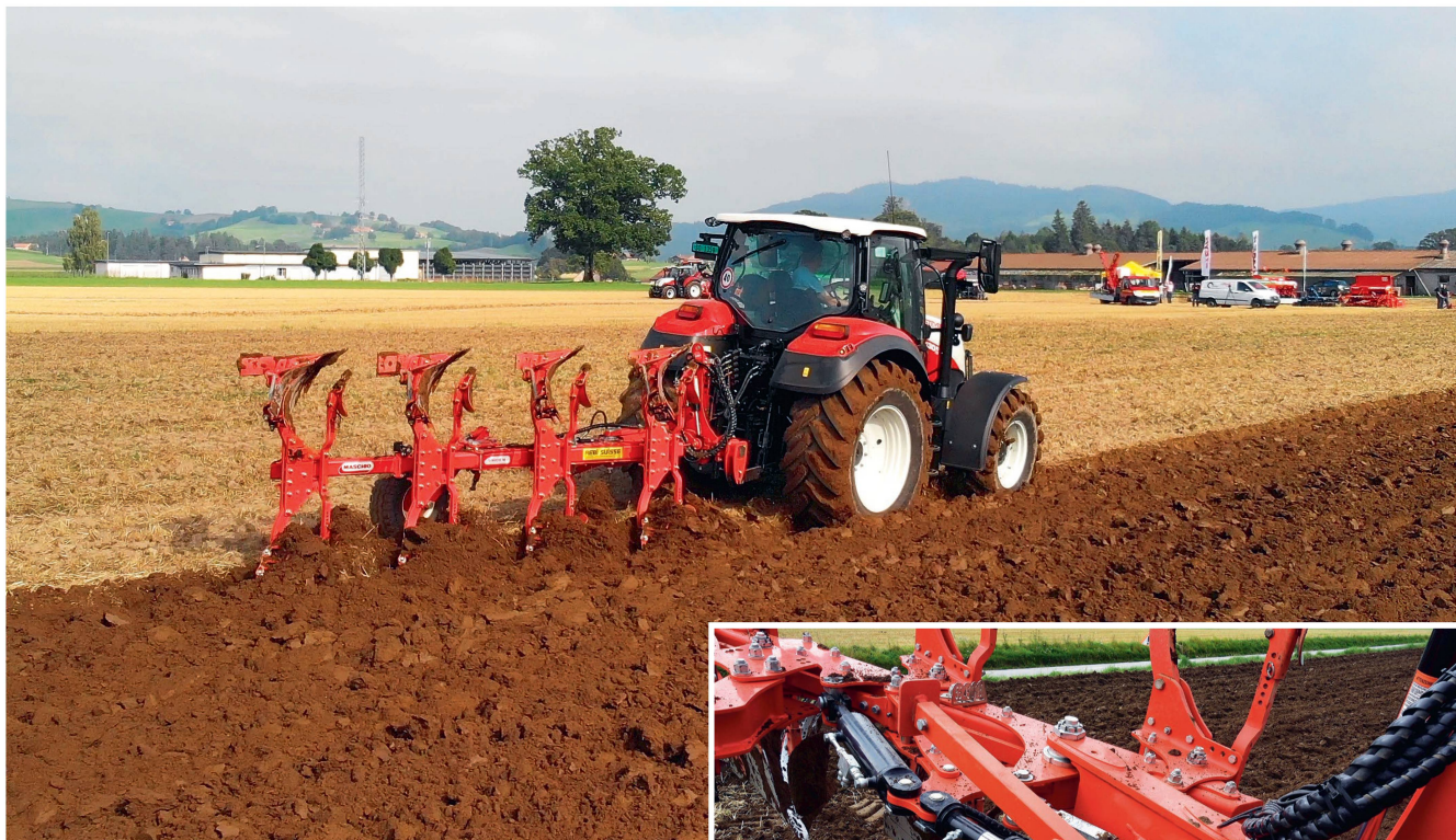
Das Einstellzentrum des «Unico» arbeitet mit zwei aneinandergebaute Parallelgrammen. Bilder: R. Burkhalter
