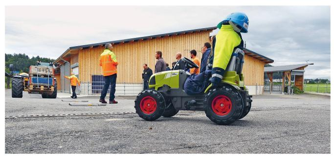
Mit Hilfe eines Spielzeugtraktors wurde die Einschränkung des Sichtfelds mit angebauter Last sichtbar gemacht. Bilder: R. Burkhalter
