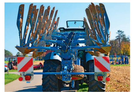
Als Anbaupflug verdeckt dieser Pflug die Beleuchtungskörper des Traktors und muss folglich Markierungstafeln, Beleuchtungskörper und runde Rückstrahler aufweisen.
