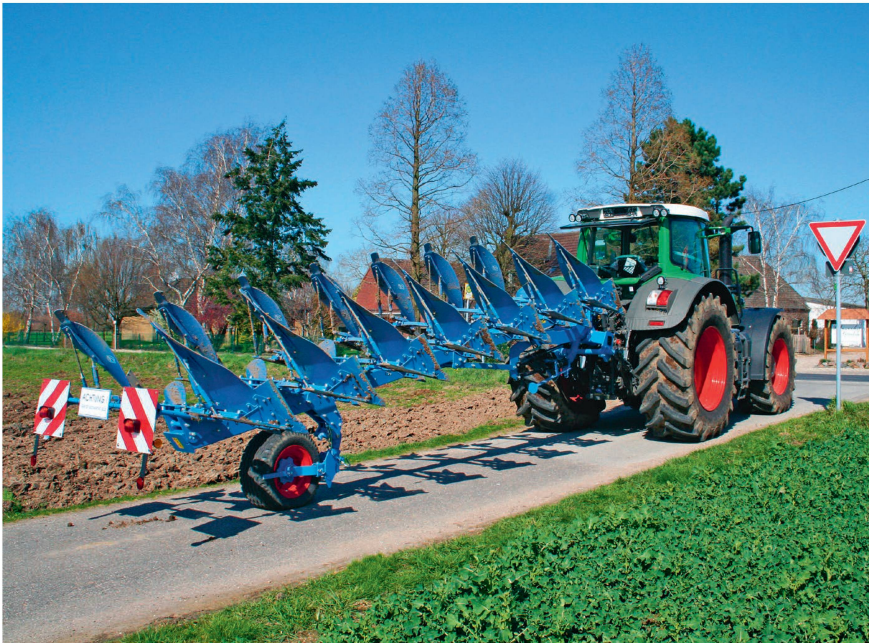
Dieser Pflug ist ein «Arbeitsanhänger». Unabhängig davon, ob er liegend oder stehend transportiert wird, sind Markierungstafeln, Beleuchtungskörper und Dreieck-Rückstrahler erforderlich. Bild: Lemken
