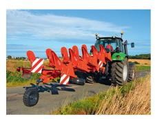
Zur Erhöhung der Sicherheit ist dieser Pflug zusätzlich mit seitlichen Markierungstafeln ausgerüstet. Bild: Kuhn
