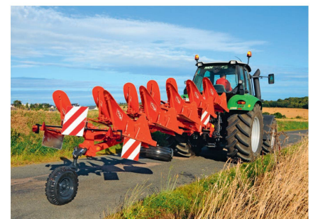
Zur Erhöhung der Sicherheit ist dieser Pflug zusätzlich mit seitlichen Markierungstafeln ausgerüstet. Bild: Kuhn
