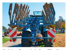
Als Anbaupflug verdeckt dieser Pflug die Beleuchtungskörper des Traktors und muss folglich Markierungstafeln, Beleuchtungskörper und runde Rückstrahler aufweisen.
