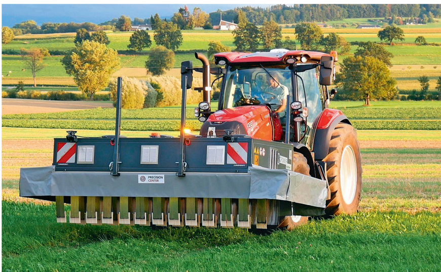
Der «XPower Electroherb» im Einsatz. Über die Applikatoren unter dem Gerät fliesst der Strom in die Pflanzen. Bilder: H. Röthlisberger
