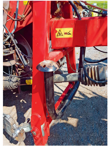
Der Stützfuß wird um 180 Grad gedreht und ist geschützt «versorgt».
