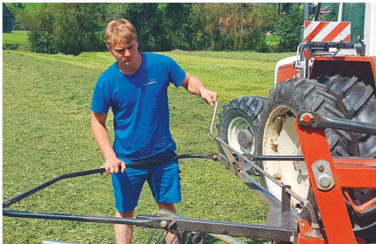
Die Arbeitstiefe wird mit einer Handkurbel eingestellt.
