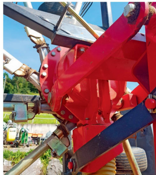
Die kardanische Kreiselauflhängung in Transportstellung.
