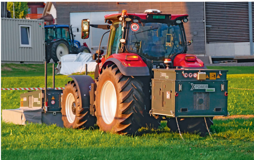
Der Generator am Heck produziert mit Zapfwellen-Antrieb den Strom. Während und bis einige Zeit nach dem Einsatz ist ein Sicherheitsabstand einzuhalten.
