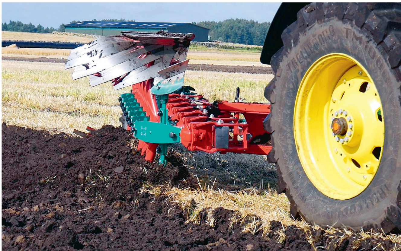
Das Onland-Pflügen ist dank GPS-Lenksystem mit RTK-Korrektursignal einfacher geworden. Das kurbelt die Nachfrage nach diesem Pflugverfahren wieder an. Bild: R. Engeler
