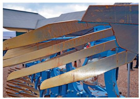
Verbesserte Stahlqualitäten können den Verschleiss um bis zu 60% reduzieren und die Standzeiten um das 2,5-Fache verlängern. Bild: R. Hunger
