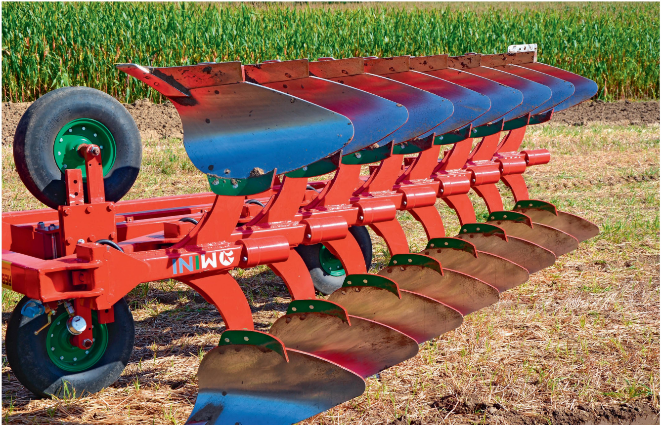
Eine exakte, flache Arbeitsweise erfordert vielfach ein 2-Rad-Fahrwerk wie bei diesem Ovlac Mini. Bilder: R. Hunger
