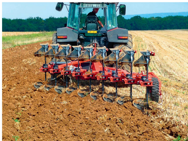
Die Pflüge für flache Bodenbearbeitung sind verhältnismässig kurz und kompakt gebaut. Bild: Bugnot
