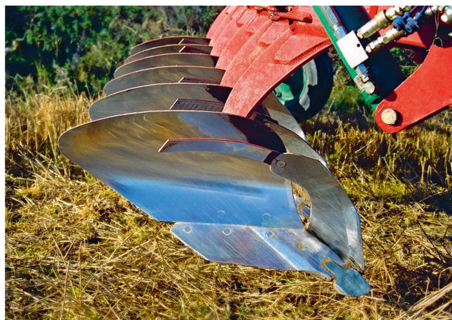
Der Kverneland «Ecomat» hat eine auffallende Kombination aus «Sech» und Stroheinleger. Bild: Kverneland
