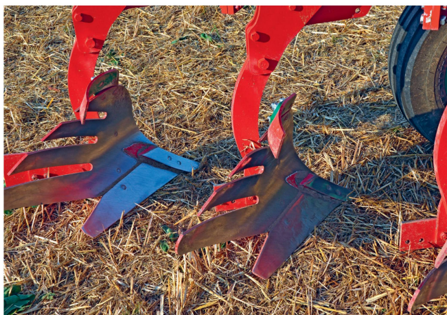
Für Schälpflüge gibt es auch eine Variante mit steil ansteigenden Streifenkörpern. Bild: R. Hunger
