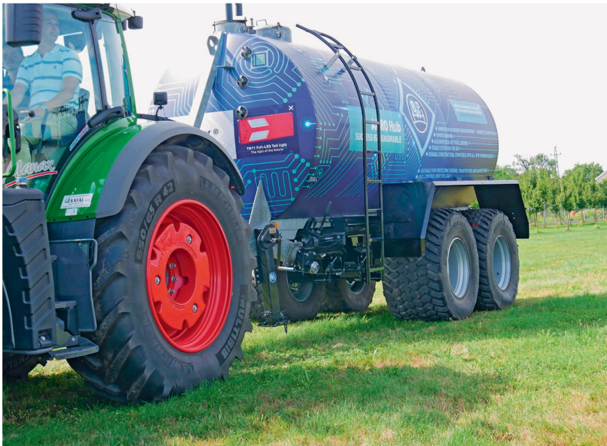
Auf diesem Fahrwerk ist ein digitales Wiegesystem von BPW verbaut. Bilder: R. Engeler
