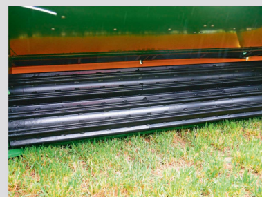
Die vier Flachriemen sind 275 mm breit. Sie können durch Betätigung einer Klinke bei geöffneter Ballenkammer entspannt werden.
