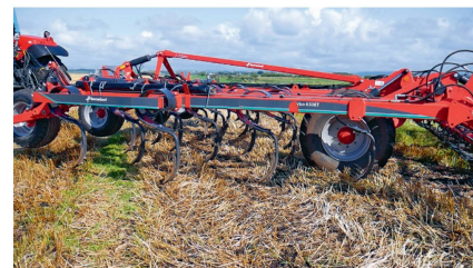
«Turbo T i-Tiller» – ein über Isobus gesteuerter, «intelligenter» Grubber schliesst die «i»-Lücke in der Bodenbearbeitung.
