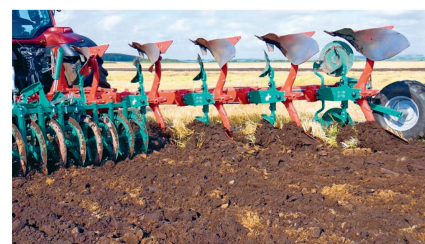
Auch beim Pflug können weitere Details verbessert werden, hier die neue Form der Grindel mit «Aero-Profil».
