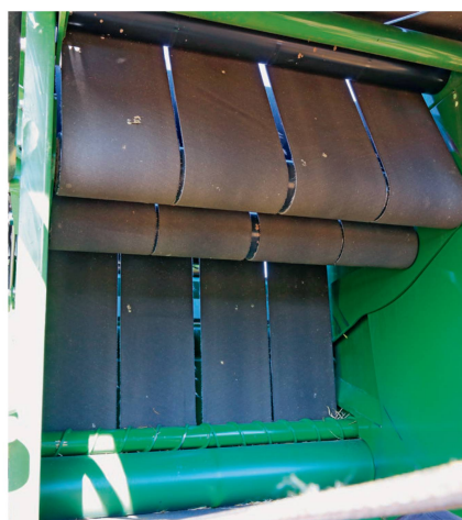
Die vier Flachriemen sind 275 mm breit. Sie können durch Betätigung einer Klinke bei geöffneter Ballenkammer entspannt werden.
