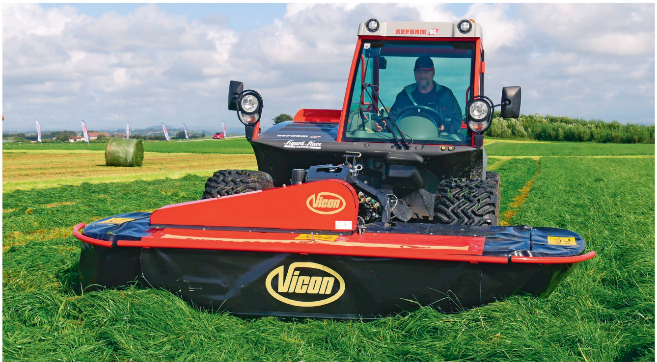
Mit dem «Extra 324 F Alpin» hat Vicon ein leichtes und kompaktes Frontscheibenmähwerk für den Einsatz in Bergregionen im Programm.
