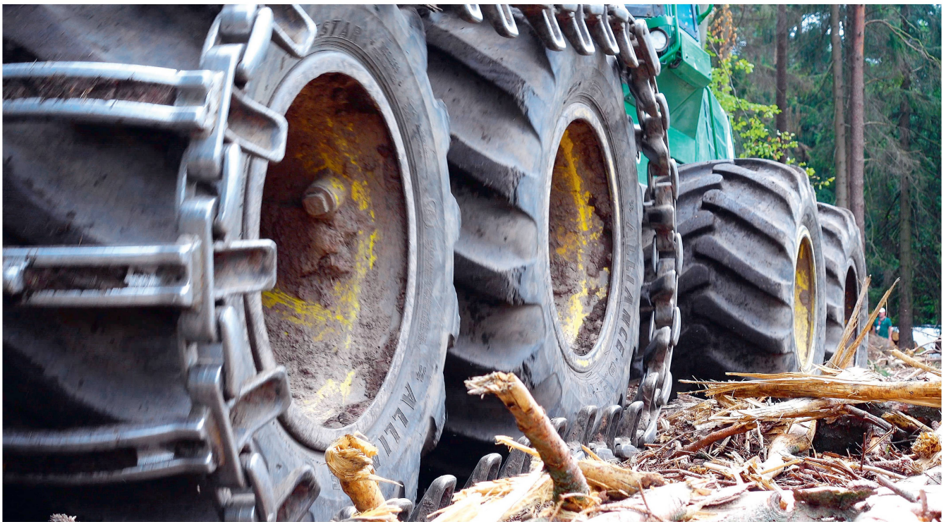
Der Reifen «344 Elit» hinterlässt dank der Niederdrucktechnik weniger tiefe Spuren auf dem Waldboden. Bilder: R. Burkhalter
