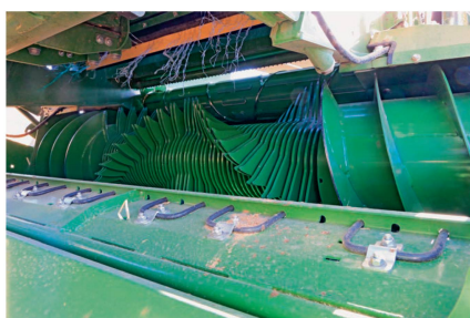
Erstmals neu in der «VariPack» ist auch der Integralrotor mit den aussenliegenden Schneckenwindungen.
