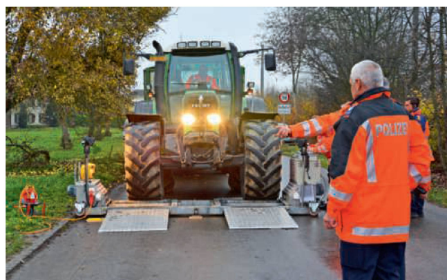
Bremsenkontrolle mit dem mobilen Prüfstand (Kapo TG).
