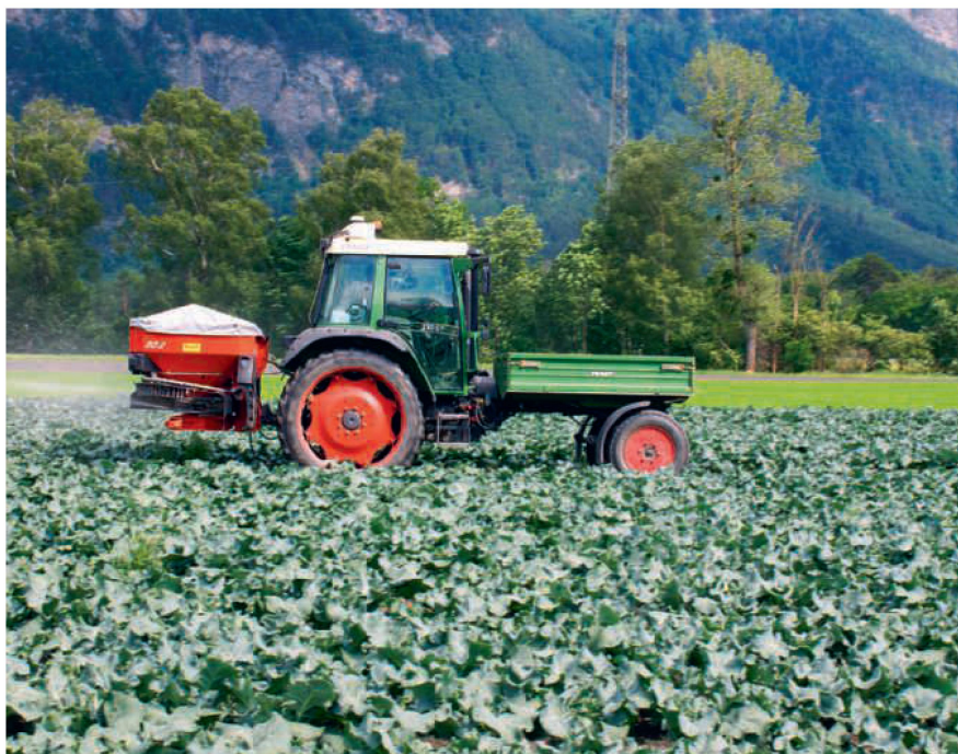
Der Fendt benötigt auch bei einer Tonne Zuladung von Dünger noch kein Frontgewicht.
