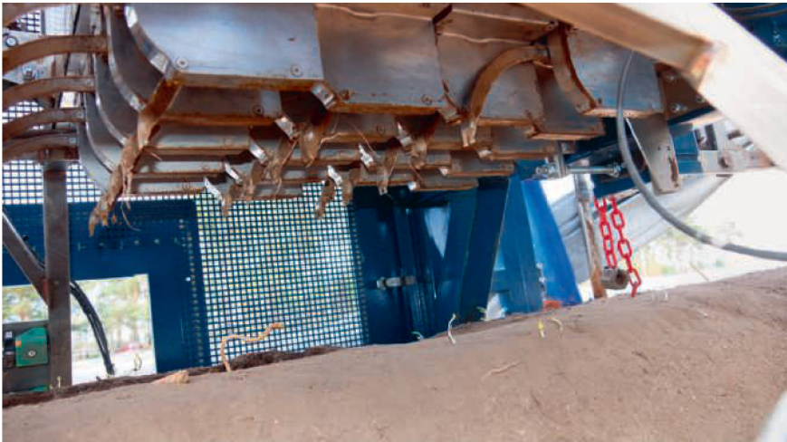
Blick auf das «Fühlerorgan»: Die (auf dem Bild hochgezogenen) Fühler sind mit Sensoren ausgestattet, die den Spargel im Boden aufspüren. Kurz vor der Berührung eines Spargels schnellen die Fühler wieder zurück.
