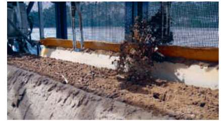
Die «Stechorgane»: Pro Reihe gibt es deren zwei, die den Spargel zusammen mit etwas Erdmaterial ausstechen, dieses abschütteln und den geernteten Spargel auf ein Förderband ablegen. Im Stecher rechts erkennt man einen Spargel, nachdem das Erdmaterial abgeschüttelt wurde.
