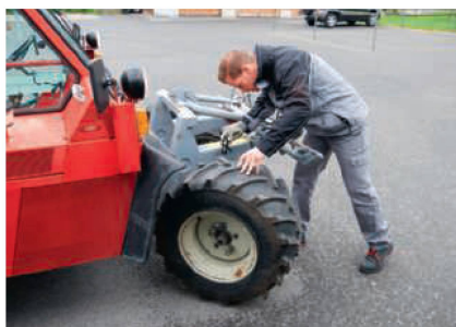
Hier wird bei einer Nachprüfung der Zustand der Achsen und der Lenkung kontrolliert.
