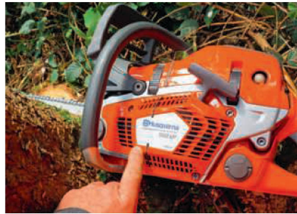
Die Fällmarkierung ermöglicht eine höhere Präzision beim Fällen.
