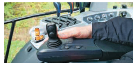
Vorne: Kreuzhebel mit elektrischer Steuerung sowie optionaler dritter und vierter Funktion für den Frontlader. Hinten: Wippschalter für die Bedienung des Getriebes.
