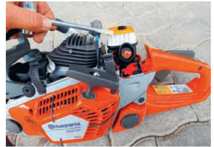
Dank dem Schnellverschluss kann der Luftfilter werkzeuglos gewechselt werden.
