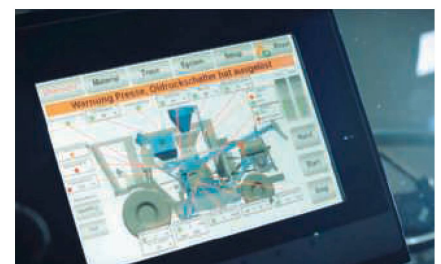
In der Kabine werden alle Funktionen der «Pelletfabrik» übersichtlich auf einem Farbbildschirm dargestellt und gesteuert.
