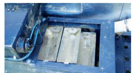
Nach dem Passieren des Rüttelsiebs werden die heissen Pellets an das Becherwerk übergeben.
