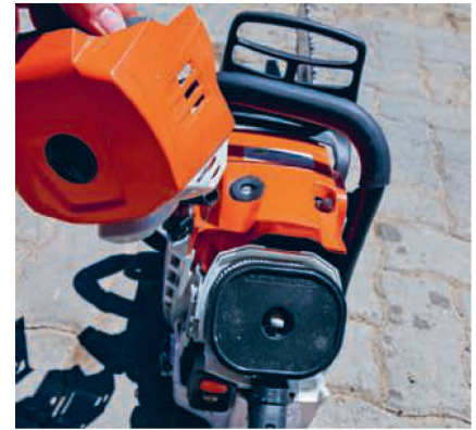
Der Filterdeckel lässt sich schnell und ohne Werkzeug lösen, was die Reinigung vereinfacht.
