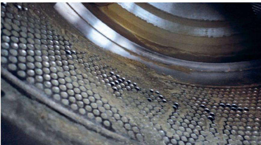
Die Ringmatrizen-Presse produziert bis zu 6 t Pellets pro Stunde.
