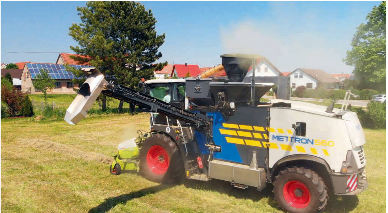
Vorbunker und Pelletbunker sind über der mittig eingebauten Pelletpresse angeordnet. Bilder: R. Burkhalter
