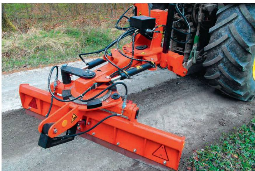
Der Spessart-Schild ist ein einseitiges Pflegegerät für den jährlichen Unterhalt. Bild: KWF
