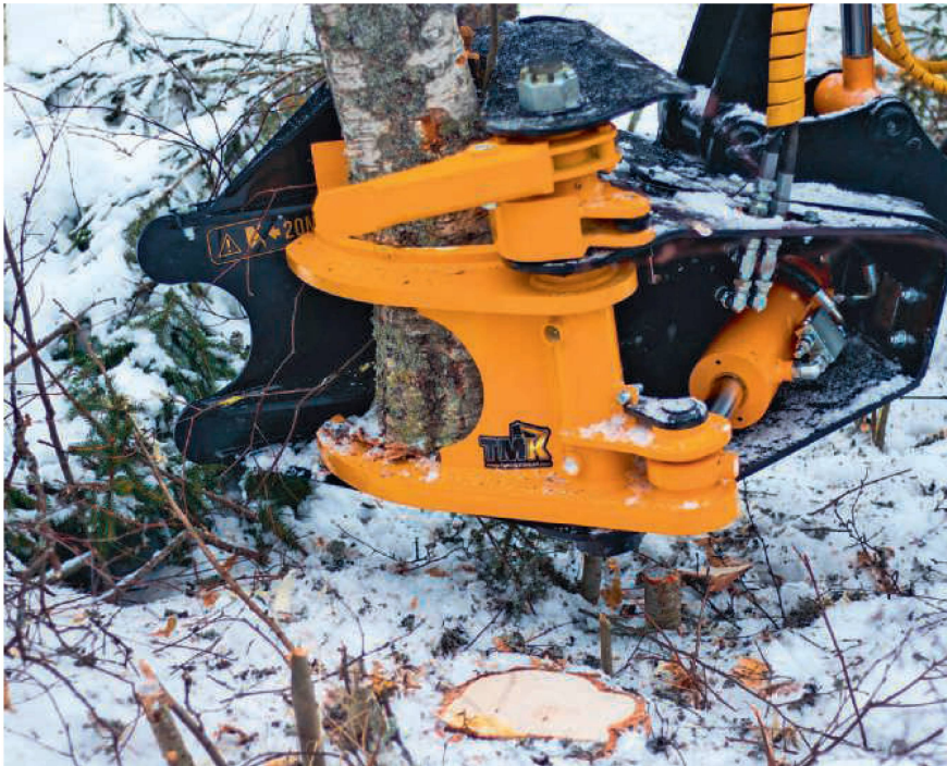
Einmal montiert, fallen mit der Baumschere keine Rüstzeiten mehr an. Bild: TMK
