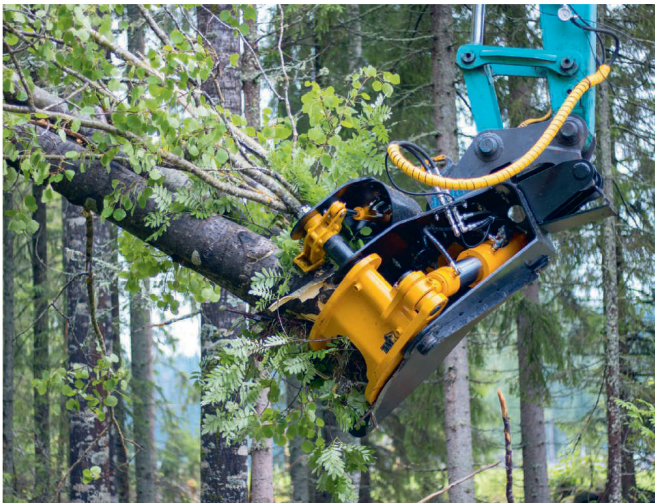
Dank Haltevorrichtung wird das geschnittene Holz gezielt abgelegt und herangezogen. Bild: TMK
