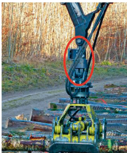
Zur Brennholzverwiegung steht mit der Kranwaage ein verlässliches System zur Verfügung. Bild: FVA
