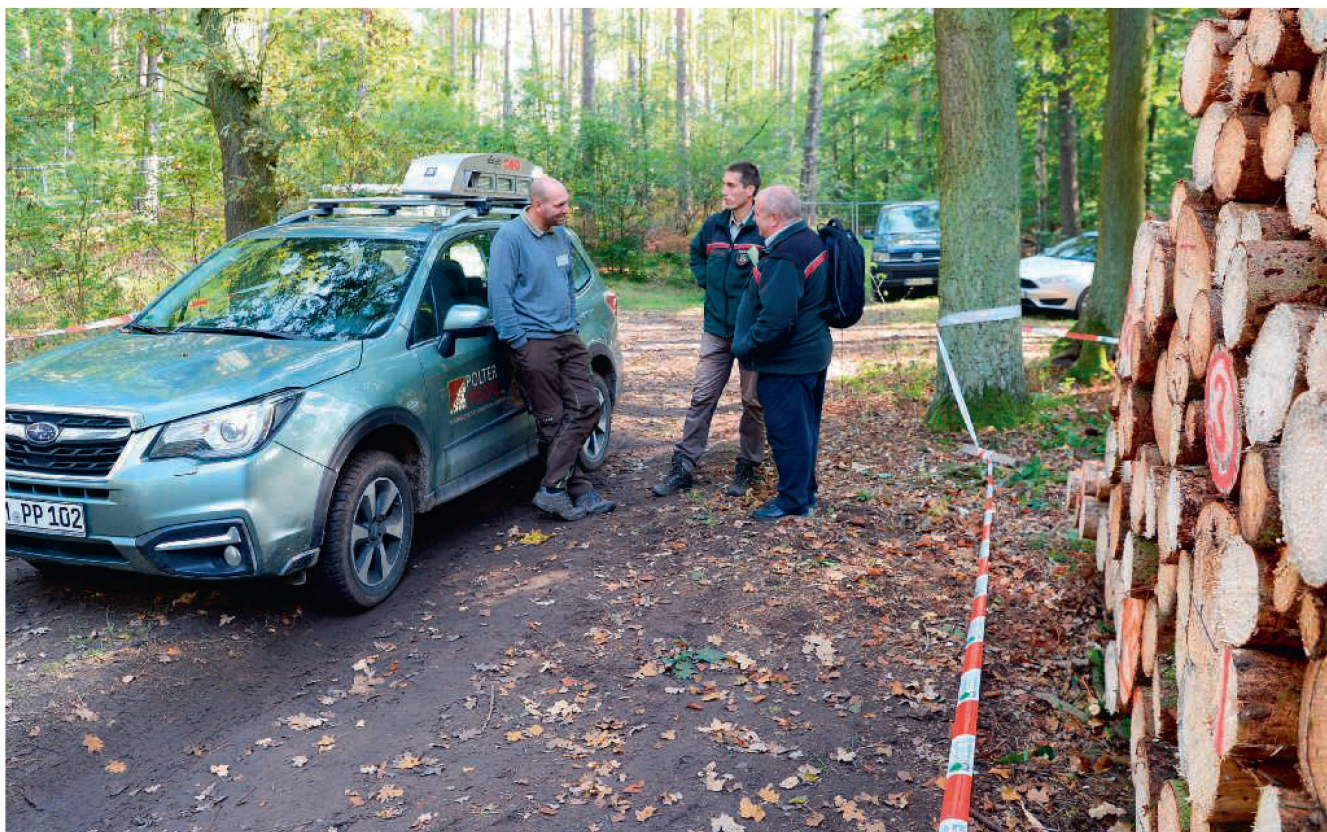
Die Vermessung von Industrieholz mittels Kamerasystem auf dem Pkw-Dach und gleichzeitiger Berechnung durch spezielle Software. Bild: KWF
