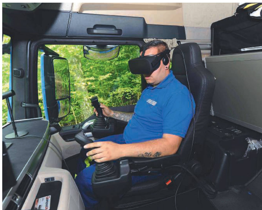
«Ich sehe etwas, das du nicht siehst!» VR-Kranbedienung in der Fahrerkabine. Bild: Hiab
