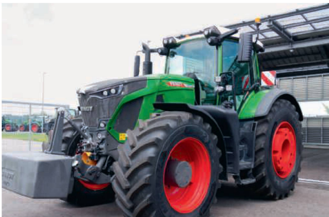
Fendt erweitert die Traktor-Baureihe «900 Vario» mit dem Modell «942 Vario» und knackt mit dem verbauten Motor von MAN die 400-PS-Schwelle.
