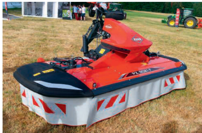
Bei den Front-Trommelmähwerken gibt es neu das «PZ 3021 F» und «PZ 2721 F» mit frei drehbaren Gleittellern.
