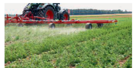
Den Striegel «Cura ST» wird Horsch als stabile und beinahe wackelfreie 3-Punkt-Variante mit Arbeitsbreiten von 6 bis 15 m auf den Markt bringen.
