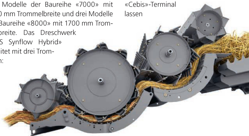
Das Dreschwerk der Schüttler heisst «APS Synflow Walker» und bietet dank zusätzlicher Abscheidetrömel deutlich mehr aktive Abscheidefläche.
