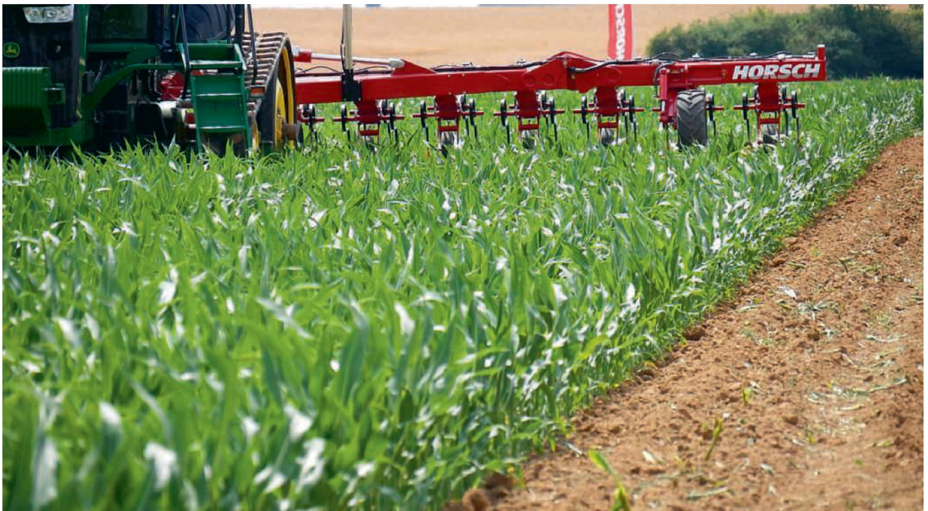
Hacken im Grossformat mit dem kameragesteuerten und 12 m breit arbeitenden «Transformer 12 VF». Bilder: R. Engeler
