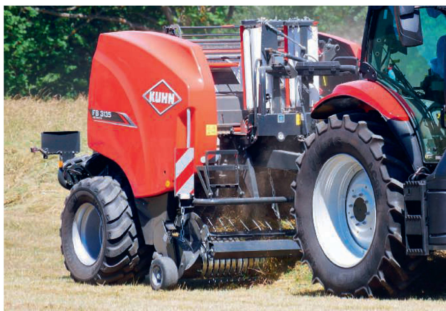
Kuhn stattet nun auch die Festkammer-Rundballenpresse «FB 3135» mit dem «Twin-Reel»-Folienbindungssystem aus. Bilder: H. Röthlisberger
