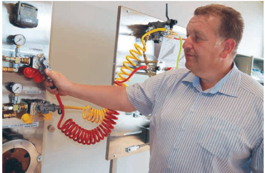
Roger Stirnimann vor dem Modell einer pneumatischen Bremsanlage: Die Energieversorgung erfolgt permanent über die rote Vorratsleitung, die Betätigung der Bremse über die gelbe Leitung.
