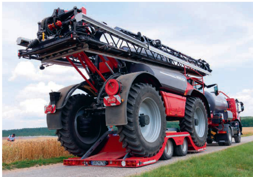
Nachtank- und Transportvorrichtung für eine in ferner Zukunft einmal autonom agierende selbstfahrende Feldspritze vom Typ «Leeb 8.300 PT».
