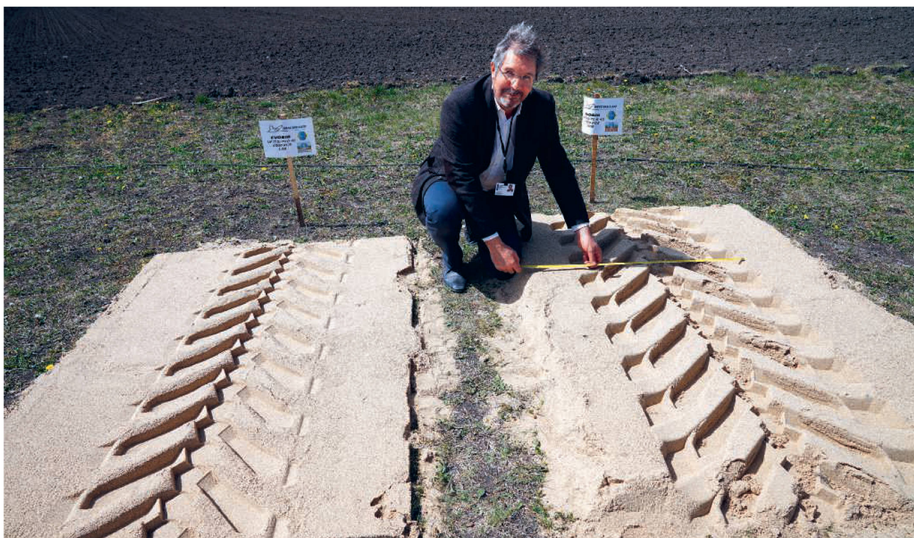
Der «EvoBib»-Reifenabdruck bei 1,8 (links) und bei 0,6 bar: Patrick Vervaeke misst die Aufstandsfläche, die sich beim niedrigeren Druck um rund 20% verbreitert. Bilder: D. Senn
