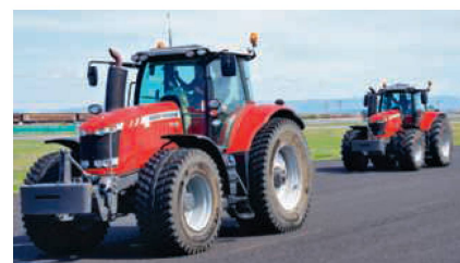
Der vordere Traktor mit den Profilblöcken des «RoadBib» rollt 49 m weiter aus als jener mit AS-Profil.
