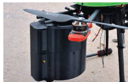
Die Bauteile für diese Abwurfvorrichtung von Trichogramma-Kapseln an Agrardrohnern von der Firma Rucon entstehen Schicht für Schicht in einem 3D-Drucker.
