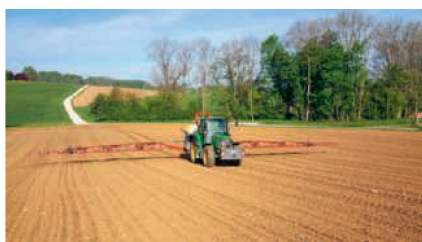
Bei Parzellen mit Fahrgassen ohne RTK-Genauigkeit können durch Einzeldüsenschaltung und Section Control Überlappungen nicht nur im Vorgewende und bei Abkehrungen, sondern auch in der Längsrichtung vermieden werden.
