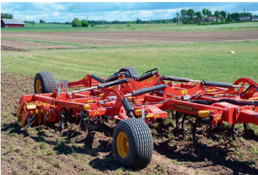
Die Bodenart, die Einsatzbedingungen und die Fahrgeschwindigkeit sind verschleissbestimmende Faktoren. Bilder: R. Hunger
