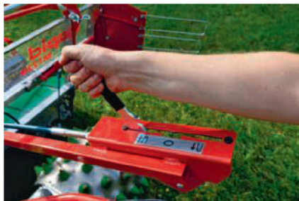
Der Richtungswechsel erfolgt mit einem lastschaltbaren Umkehrgetriebe.
