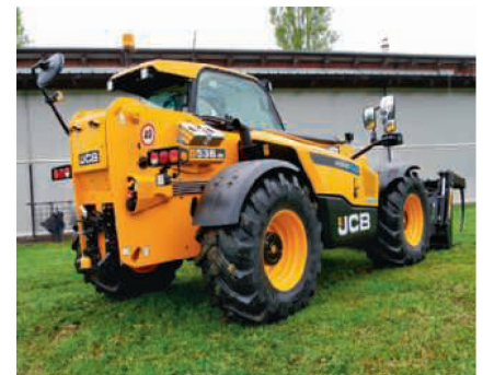
Dank tief gehaltenem Ausleger und Motor ist eine gute Sicht nach rechts möglich.
