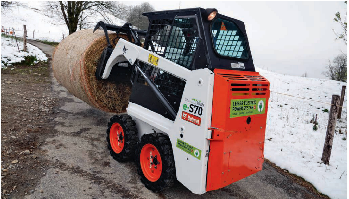
Von aussen ist der Elektro-Bobcat kaum von der Originalversion mit Dieselmotor zu unterscheiden. Bilder: R. Burkhalter/zvg
