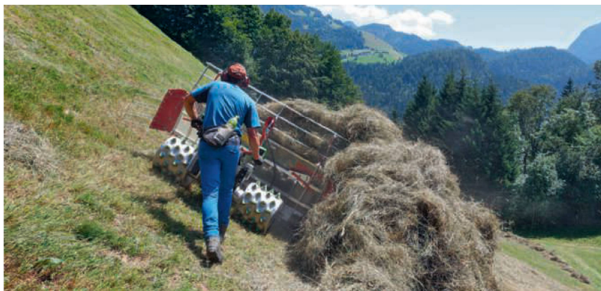
Beim Abräumen grosser Futtermengen von Steilhängen ist das optionale Aufbaugitter ein Muss.
