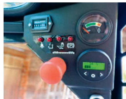
Im Führerstand erinnern nur das Potenziometer zur Drehzahlregelung und die Akkuanzeige daran, dass man im E-Bobcat sitzt.
