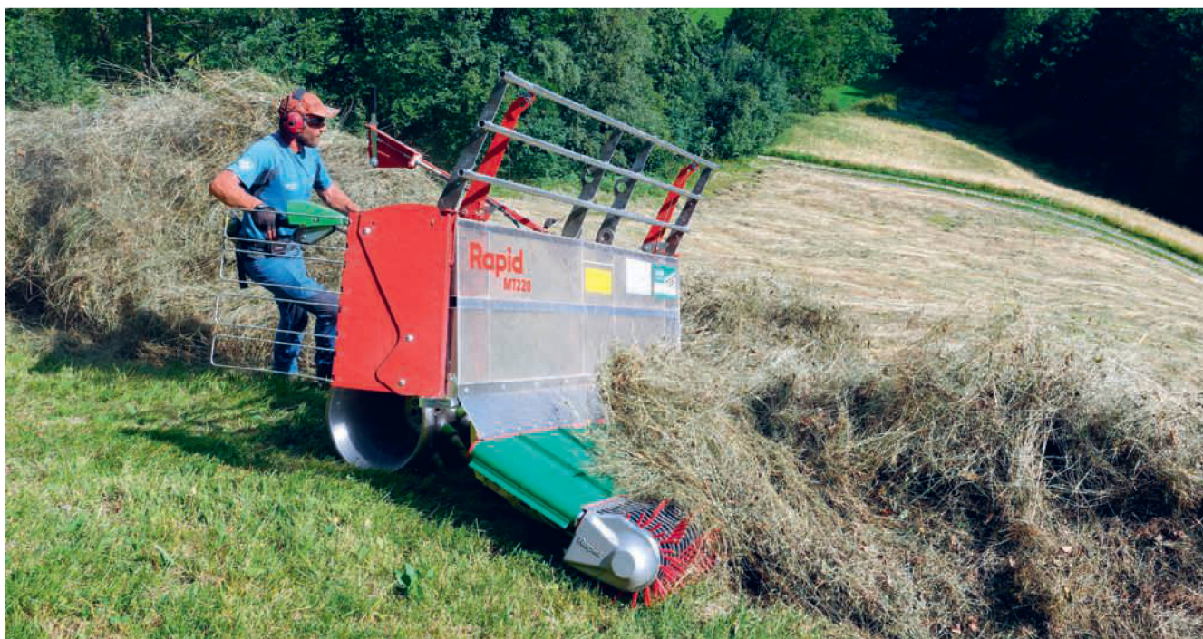
Der Rapid «Multi-Twister 220» im Testeinsatz. Das vom Pick-up aufgenommene Futter wird vom Förderband aktiv zur Seite transportiert.
