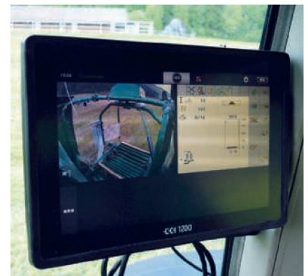
Das «CCI 1200» zeigt dem Fahrer neben dem Pressenstatus auch eine Kameraansicht an.
