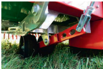
Die Zwillings-Tasträder für die Tiefenführung lassen sich beidseitig mit einem Handhebel und einer Lochleiste in der Höhe verstellen.
