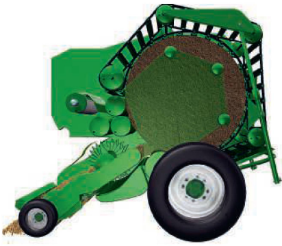
In der semivariablen Kammer wird der Ballen durch den «NovoGrip»-Stabgurtförderer geformt, ist zuerst eckig, dann rund.
