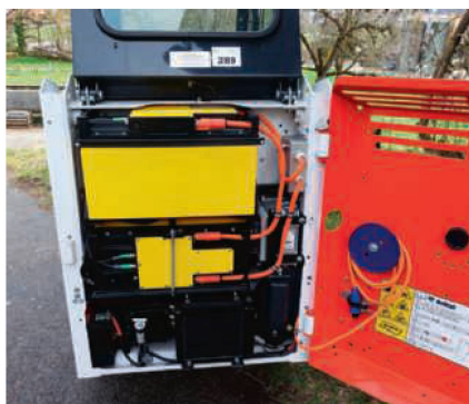
Bei geöffneter Heckklappe sind die zwei Akkus und rechts davon das Ladegerät sichtbar, nicht aber der Elektromotor.
