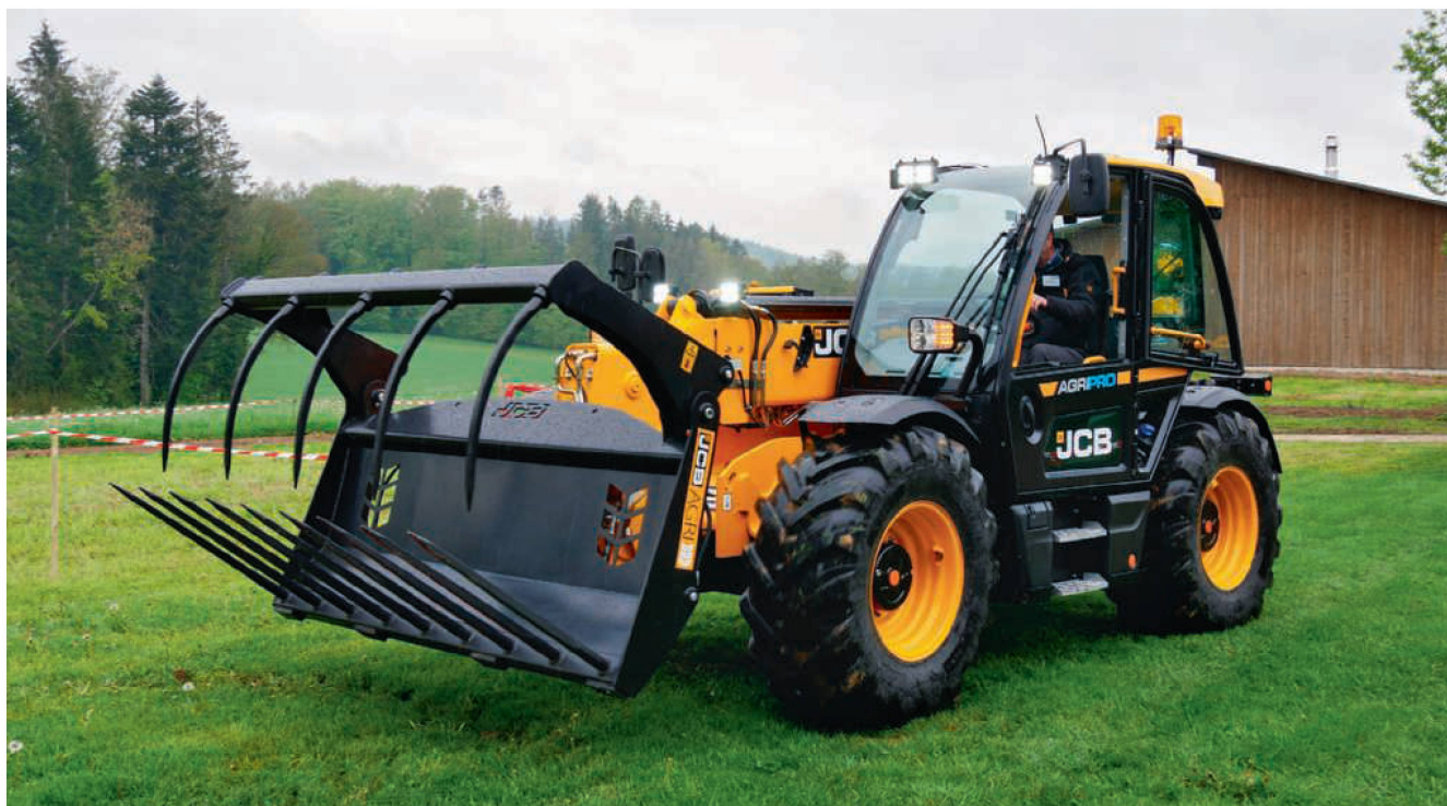
Der «536-95 AgriPro» aus der neuen «Serie III» hat 3600 kg Hubkraft und eine Hubhöhe von 9,5 m. Bilder: H. Röthlisberger
