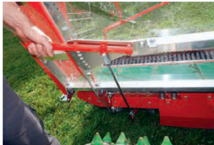
Die Zwillings-Tasträder für die Tiefenführung lassen sich beidseitig mit einem Handhebel und einer Lochleiste in der Höhe verstellen.
