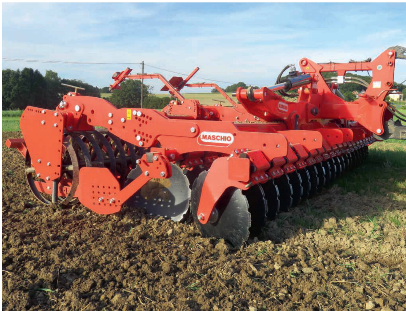
Kurzscheibenegge und Packerwalze sind ein beliebtes «Gespann» für die Stoppelbearbeitung. Bilder: R. Hunger, Konrad Merk und zvg
