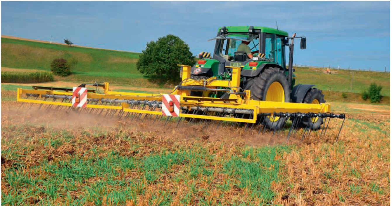
Strohstriegel verteilen Ernteresten und zerstören frisch aufgelaufene Unkrautkeimlinge. Bilder: R. Hunger
