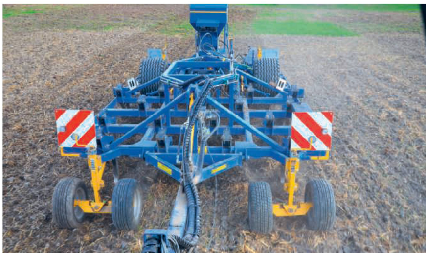
Gezogener 4-Balken-Präzisionsgrubber mit vorlaufendem Pendelfahrwerk.
