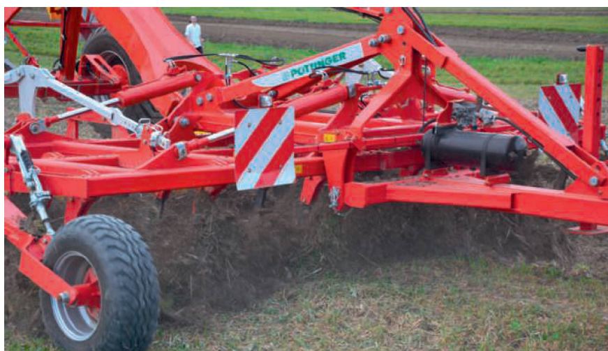
Geschwindigkeit und Arbeitstiefe bestimmen den Arbeitseffekt.
