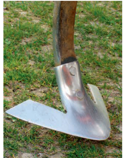
Mit der Gänsefuss-Schar kann flach gearbeitet werden, sie mischt aber nur mässig.
