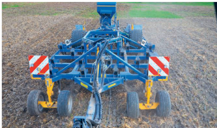
Gezogener 4-Balken-Präzisionsgrubber mit vorlaufendem Pendelfahrwerk.
