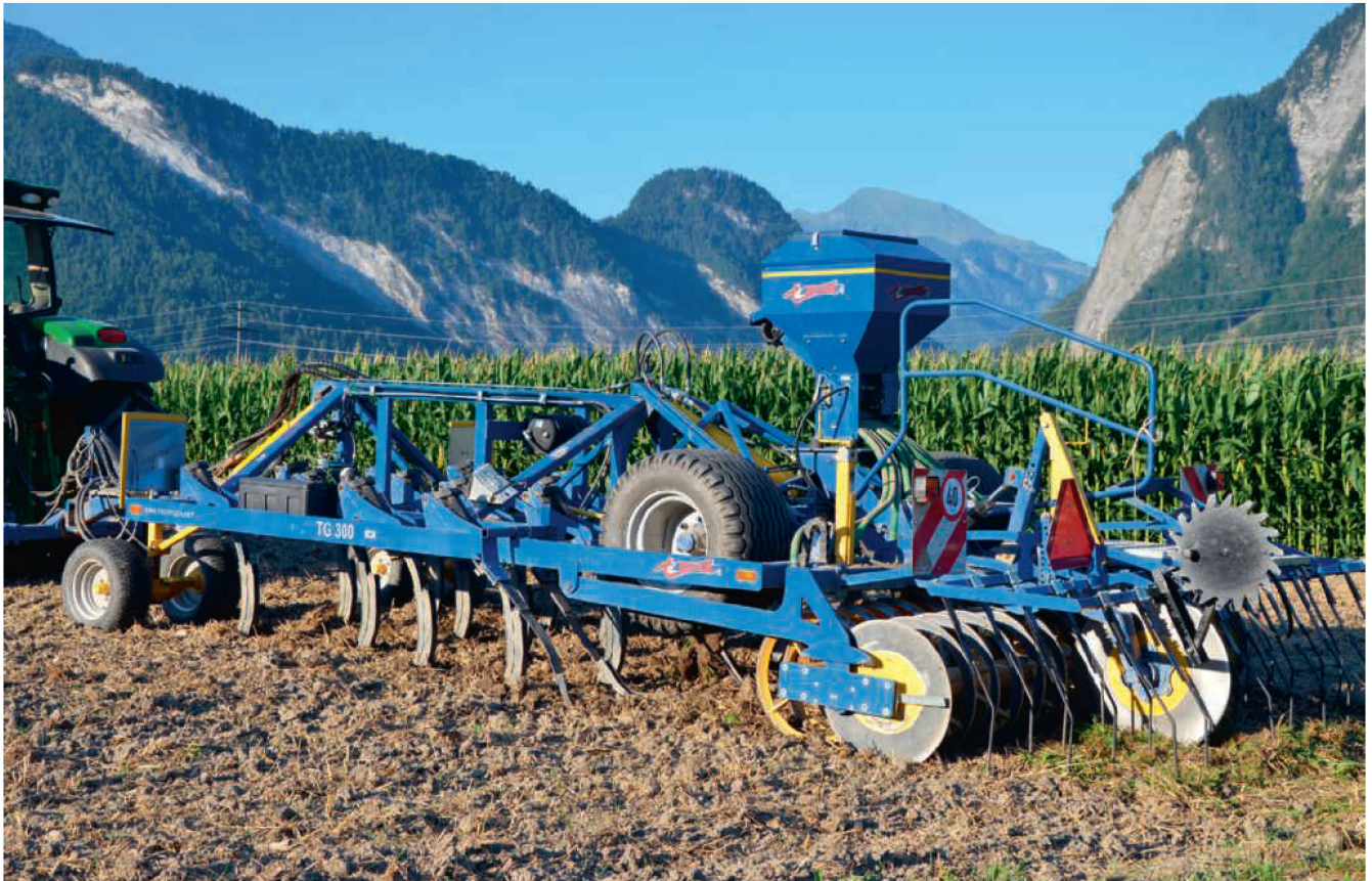
Präzise Tiefenführung wird durch Fahrwerk und Walze sichergestellt. Bilder: R. Hunger und zvg
