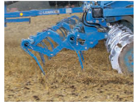
Ein Strohsriegel als Vorbau verteilt organisches Material gleichmässig vor den Scheiben. Bild: Lemken
