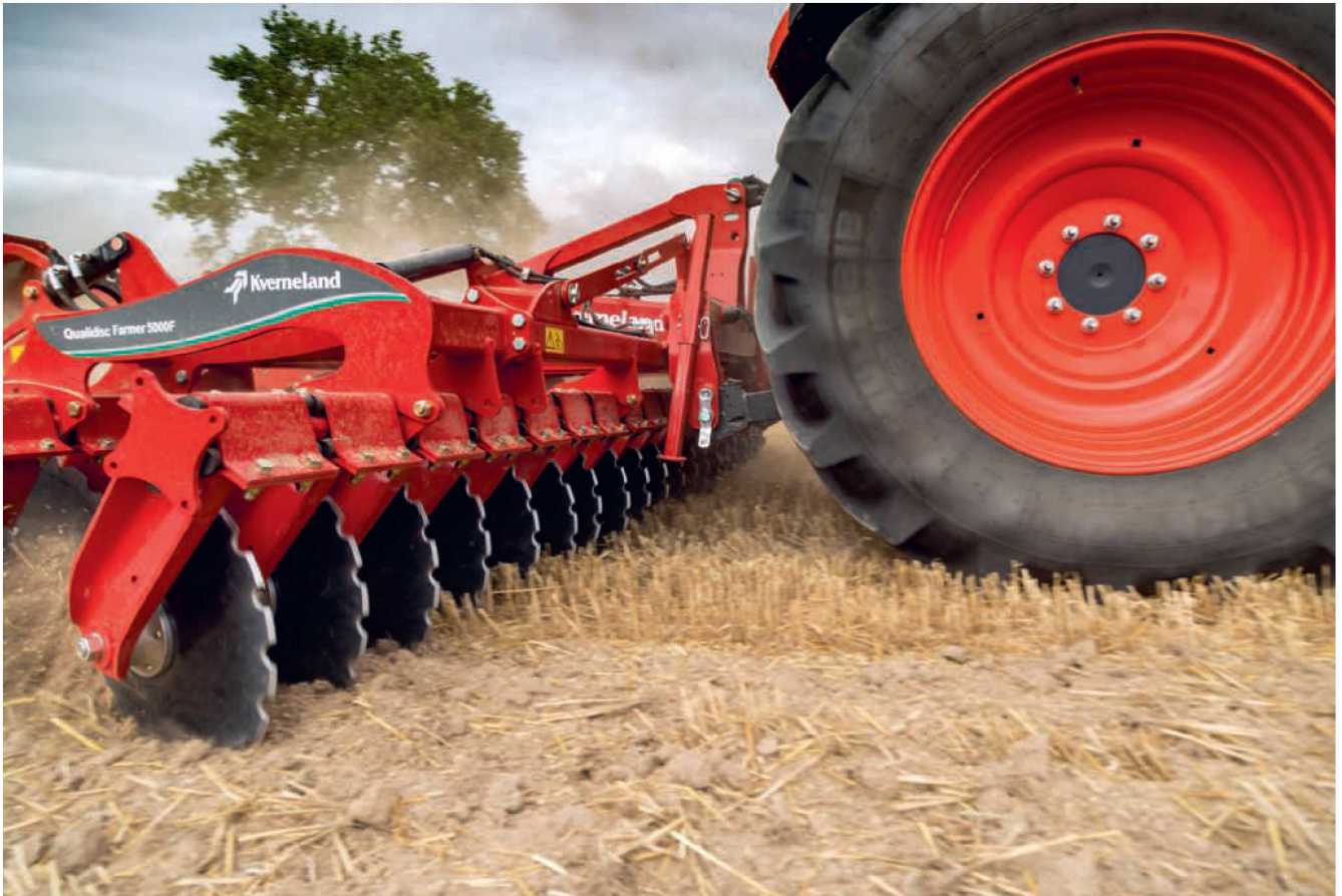
Die fein gezackten Scheiben erleichtern den Einzug und ermöglichen ein flaches Arbeiten. Bilder: R. Hunger
