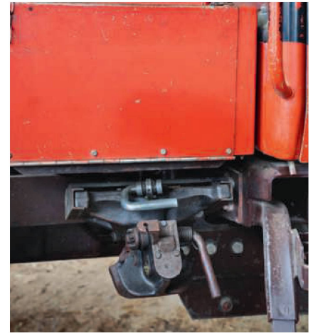
Praktische Halterung für die Rockinger-Anhängekupplung; so ist die Zugöse auch bei Nichtgebrauch immer mit dabei.
