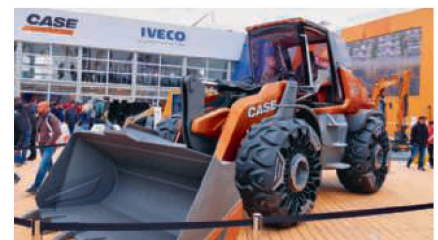
Das Projekt «Tetra» eines Radladers mit Gasmotor von Case, ausgestattet mit «Tweel»-Reifen von Michelin, die ohne Luft funktionieren.
