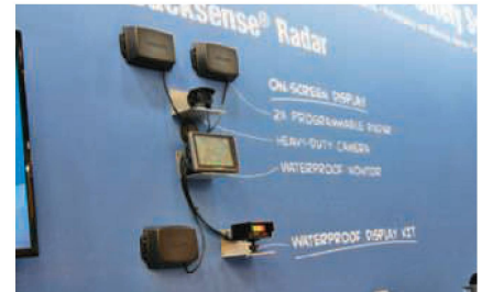
Das Radarwarnsystem «Backsense» von Brigade-Elektronik warnt Fahrer mit abgestuften Hinweisen vor beweglichen oder stationären Hindernissen.
