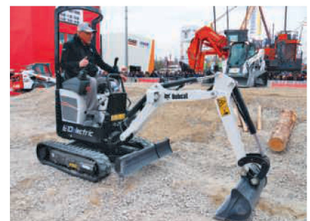
Klein und elektrisch: Erster vollelektrischer Minibagger «E10e» von Bobcat in der 1-t-Klasse mit Kurzheckbauweise.
