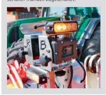
zungen aus der Praxis müssen mehr als 2000 Traktoren mit ihren Anbaugeräten mit solchen Kamera-Monitor-Systemen ausgerüstet werden. Gerade bei 6-Zylinder-Traktoren werden die 4 m vorderer Überhang meist überschritten und oft werden sogar 5 m vorderer Überhang ohne Probleme erreicht. Eine Nachmessung ist unbedingt zu empfehlen.
