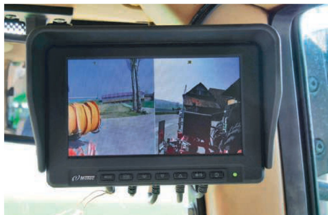
Der Motec-Monitor zeigt die zwei Kamera-Bilder gesplittet auf einem 7-Zoll-Bildschirm an.
