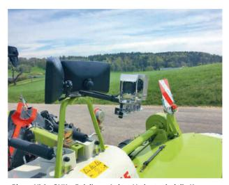
${\it ``Blaser-Visio-QVK''}. \ Bei \ dieser \ Anbau-Variante \ sind \ die \ Kameras \ direkt \ auf \ dem \ bestehenden \ Doppelspiegelhalter \ montiert.$
