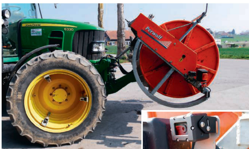
Für «hohe» Frontanbaugeräte bietet Remund + Berger eine Montage-Variante seitlich des Gerätes an.
