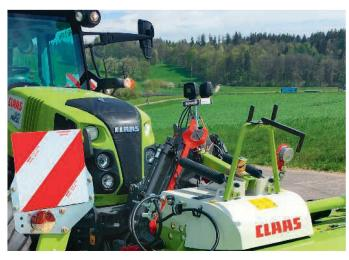
Hier ist das Kamera-System «Blaser-Visio-QVK» in Kombination mit einem Blinklicht auf dem Anbaubock montiert.
