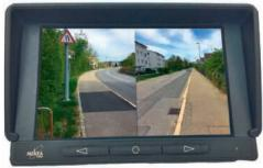
Beim Kamera-Monitor-System von Blaser kann zwischen einem gesplitteten 7-Zoll-Monitor oder der Kombination von zwei 7-Zoll-Monitoren gewählt werden.
