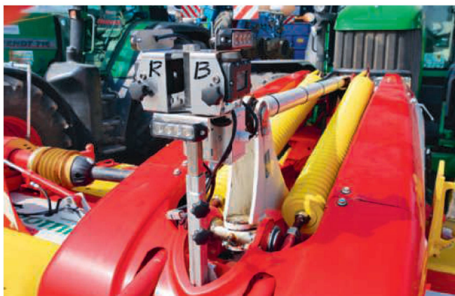
Das Vorbau-Kamera-Monitor-System VKMS (Motec) mit Blinklicht, aufgebaut auf einem Schnellwechselsystem von Remund + Berger.
