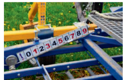
Die Feder-Vorspannung kann der Fahrer anhand einer Skala mit grossen Zahlen wählen.
