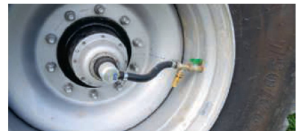
Die 750er-Bereifung sorgt in Kombination mit einer Reifendruckregelanlage für maximale Bodenschonung.
