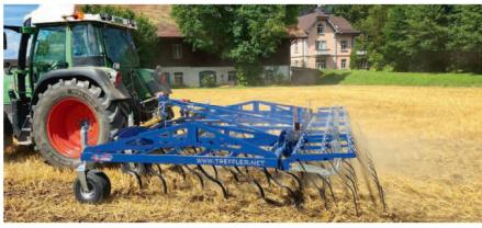
Der flache Federstahlzinken und das massive Fahrwerk sind Merkmale der «TF 530».
