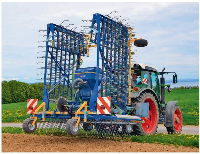
9 m Arbeitsbreite, 5 Zinkenfelder, 6-Rad-«Fahrwerk» und Sägerät zeichnen diesen Striegel von Treffler aus. Bilder: R. Hunger
