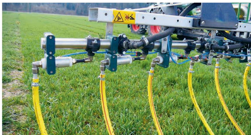
Anstelle von Düsen gibt es am Spritzbalken sogenannte Quetschventile aus Edelstahl.
