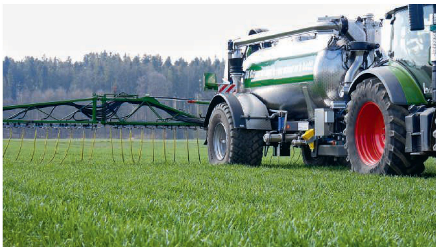
Das Pumpfass bringt den Dünger via 10 Teilbreiten und insgesamt 60 Ventile über feine Schläuche bodennah und emissionsmindernd aus. Bilder: R. Engeler
