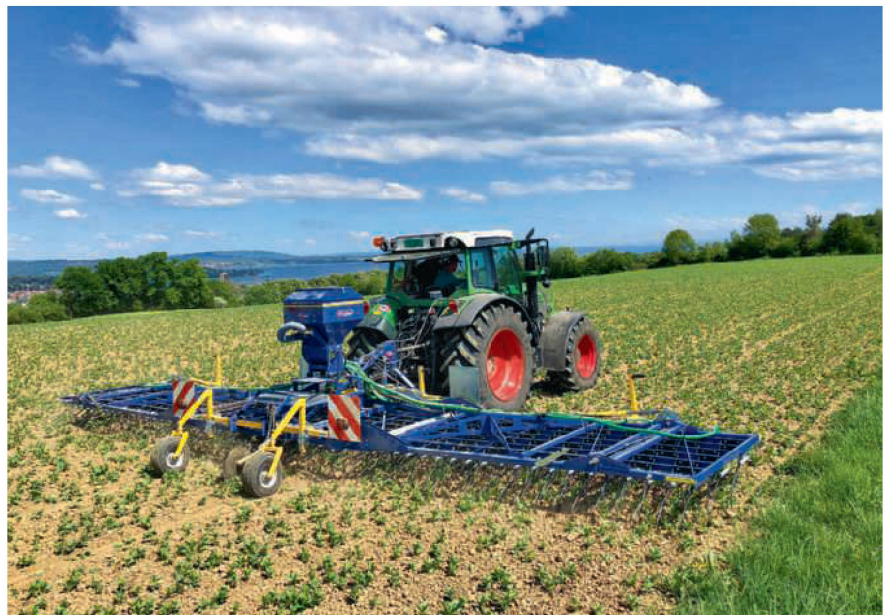
Bei 9 m Arbeitsbreite übernehmen die Stützräder die gleichmässige Tiefenführung.
