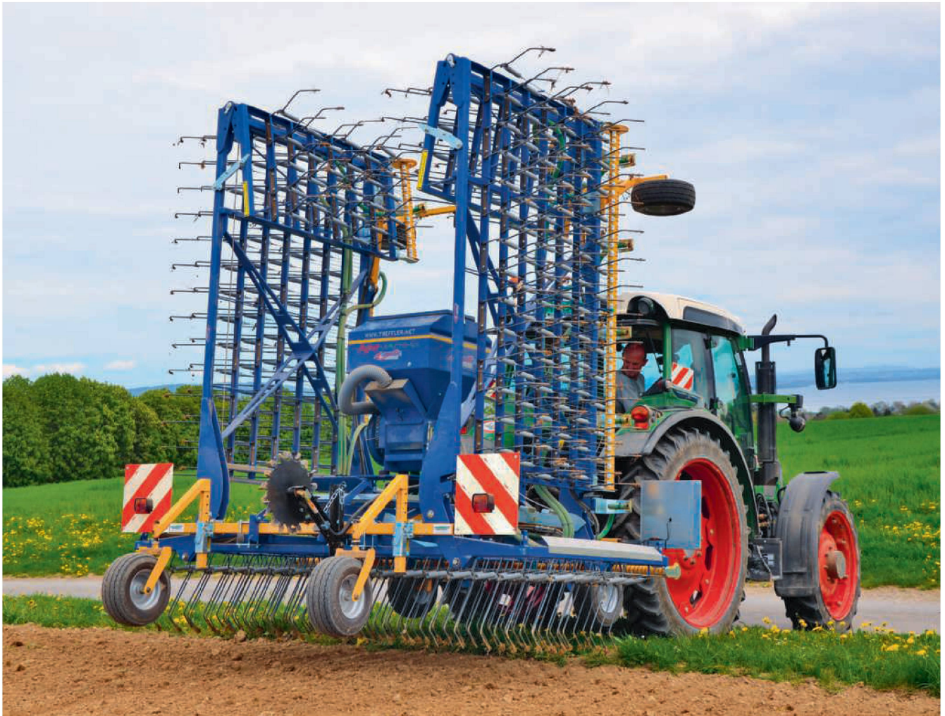
9 m Arbeitsbreite, 5 Zinkenfelder, 6-Rad-«Fahrwerk» und Sägerät zeichnen diesen Striegel von Treffler aus. Bilder: R. Hunger
