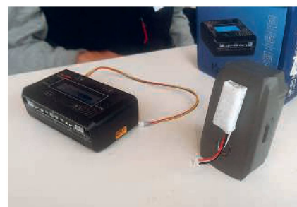
An der «Mavic»-Drohne sind keine Anpassungen nötig. Sie kann jederzeit auch wieder ohne «BambiKam» benutzt werden. Am Flugakku wird der Zusatzakku geklebt.
