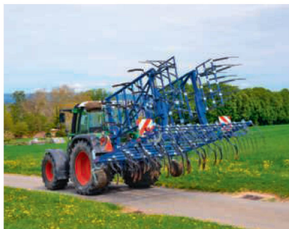
Kompakt geklappt, gibt man der «TF 530» die über 5 m Arbeitsbreite nicht.
