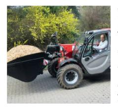
me Hubkraft von 2.5 t sowie die Hubhöhe von 6 m, verpackt in einer unschlagbaren Kompaktheit mit einer Breite ab 1.8 m und einer Höhe von unter 2 m. Kombiniert mit einer ganzen Reihe von Pluspunkten wie dem geringen Wenderadius, dem komfortablen Einstieg, der aufgeräumten Kabine mit Klimaanlage und dem patentierten JSM Joystick, welcher eine sehr feinfühlige Bedienung ermöglicht, ist der MLT 625 Elite der perfekte Partner für alle Arbeiten auf dem Hof von Albert Schmid.
