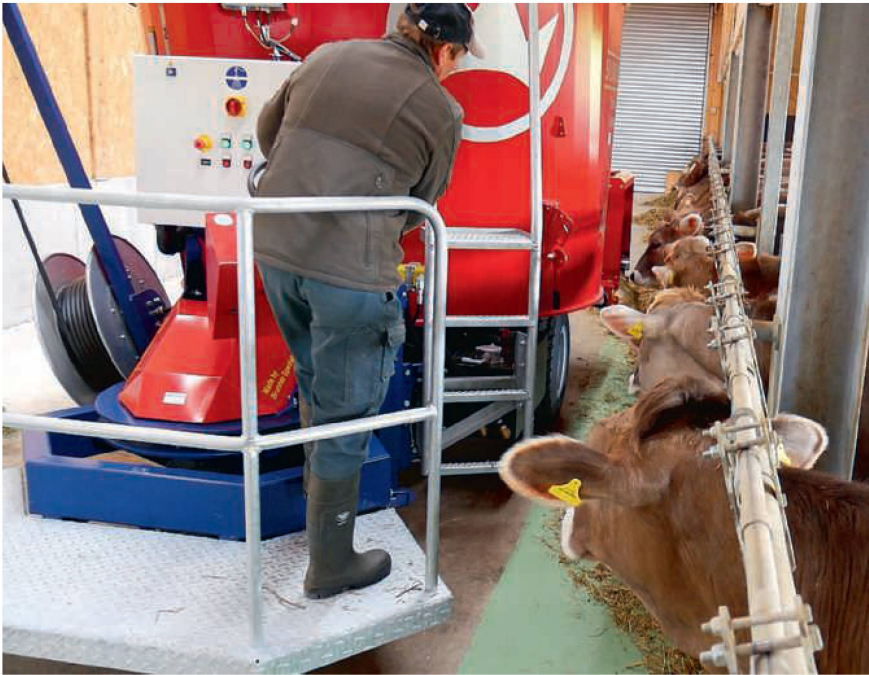
Die Bedienungsarmatur mit Lenkrad kann man nach links und rechts schwenken. Bilder: R. Engeler
