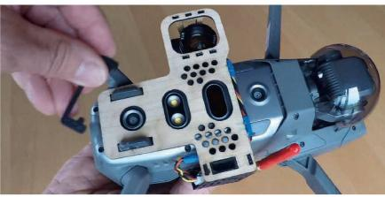
Die benötigten Komponenten werden mit einer ultraleichten Konsole als Einheit an der Drohne befestigt.
