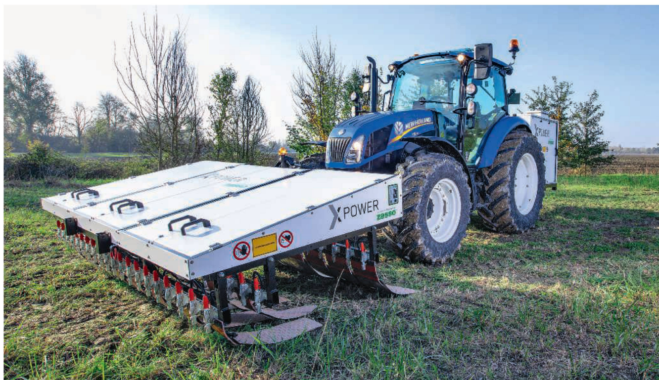
Laut CNHi soll die XPower-Technologie zur Einleitung von Strom in den Boden «ab» 2019 verfügbar sein. Bild: CNH/Zasso
