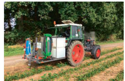
Randbehandlung mit heissem Wasser oder Heisswasser/Dampf. Bild: Keckex
