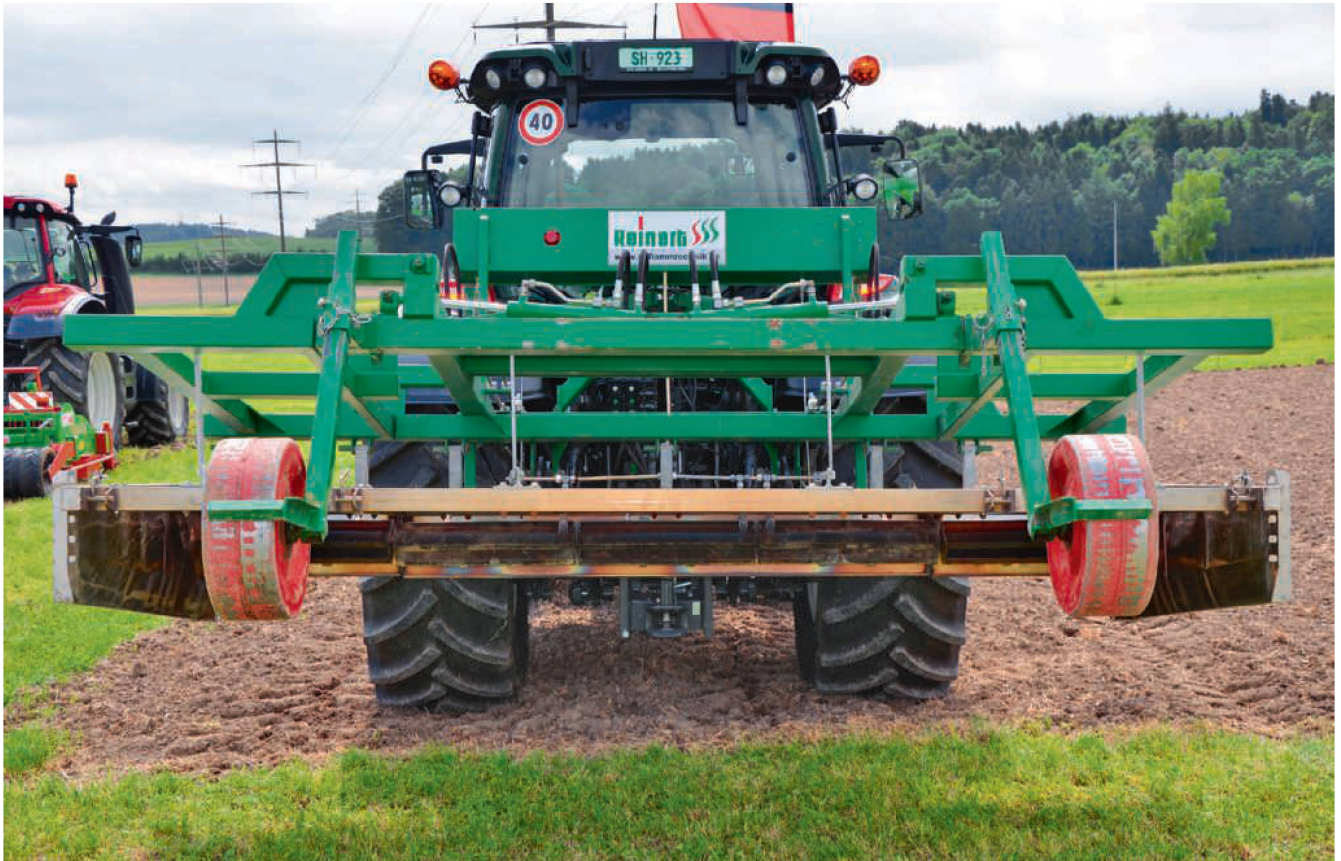
Abflammentechnik als Alternative zum chemischen Pflanzenschutz. Bild: R. Hunger
